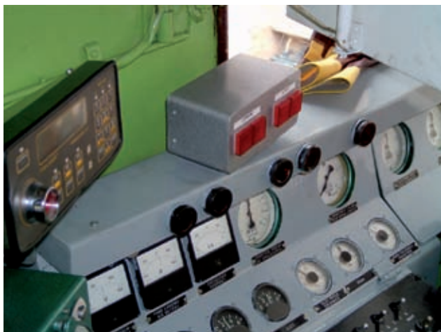
Rys. 10. Zespół lampek sygnalizacyjnych CA i SHP zabudowany na pulpicie sterowniczym lokomotywy TEM2
