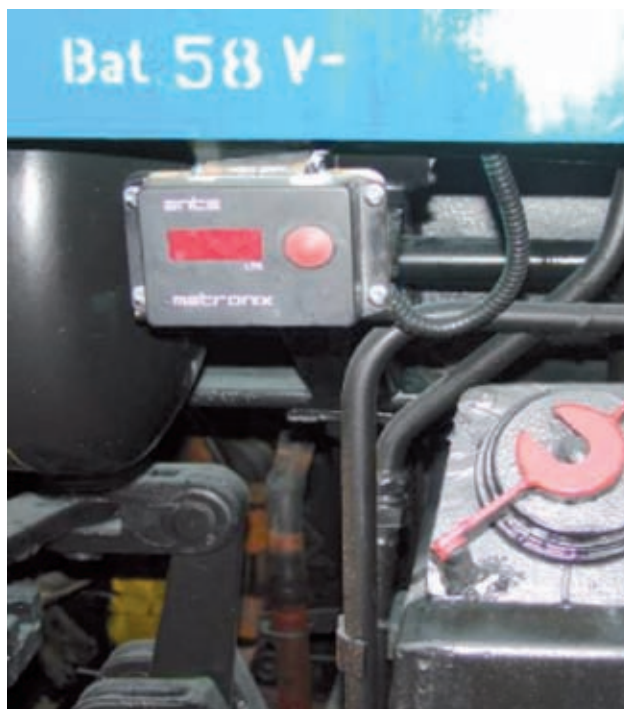
Rys. 36. Wskaźnik poziomu paliwa z sygnalizatorem akustycznym napiełniania firmy Ente Gliwice
