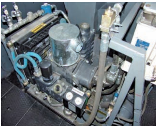
Rys. 28. Śrubowa sprężarka powietrza z napędem hydrostatycznym firmy Gardner Denver
