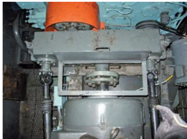
Rys. 26. Napęd z prądnicy na skrzynki przekładniowe przenoszony za pośrednictwem sprzęgła elastycznego
