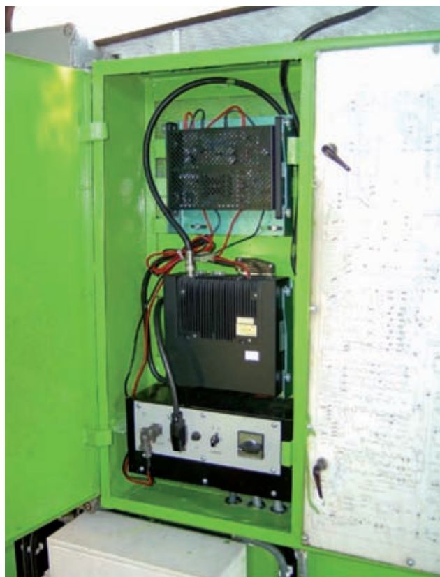
Rys. 13. Zasilacz i zespół nadawczo-odbiorczy w lokomotywie TEM2
