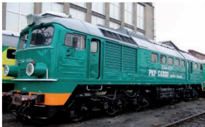
Rys. 18. Lokomotywy ST44 z silnikiem typu 12CzN26/26 z przeznaczeniem dla PKP CARGO S.A.
