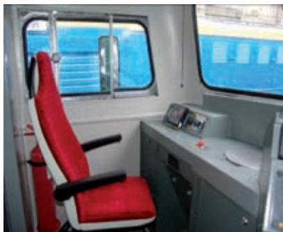
Rys. 21. Stanowisko pomocnicze – nowoczesny fotel (po lewej) i konsola pulpitu pomocniczego (terminal maszynisty, sterowanie klimatyzacją i kuchenka elektryczną)
