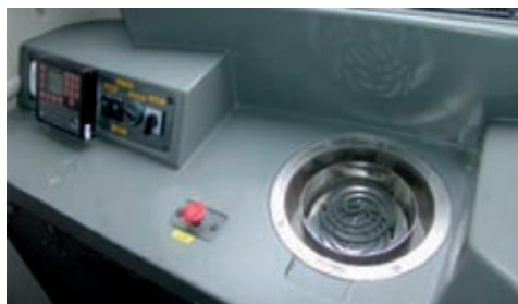
Rys. 21. Stanowisko pomocnicze – nowoczesny fotel (po lewej) i konsola pulpitu pomocniczego (terminal maszynisty, sterowanie klimatyzacją i kuchenka elektryczną)
