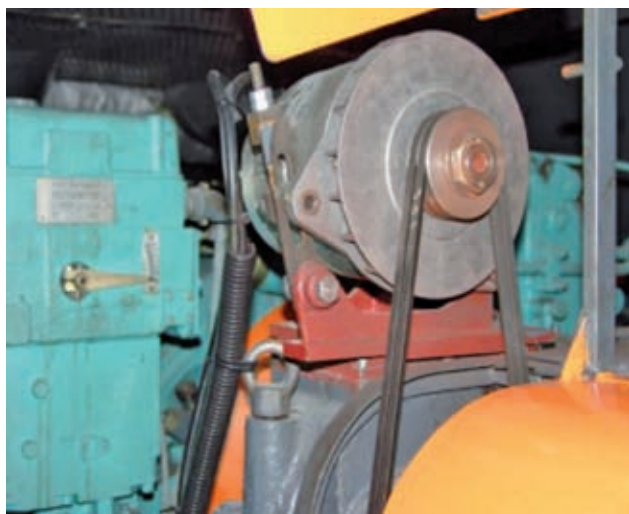
Rys. 30. Prądnica pomocnicza firmy Bosch (24V DC, 120A) do zasilania klimatyzatora i chłodnicy oleju hydrostatycznego
