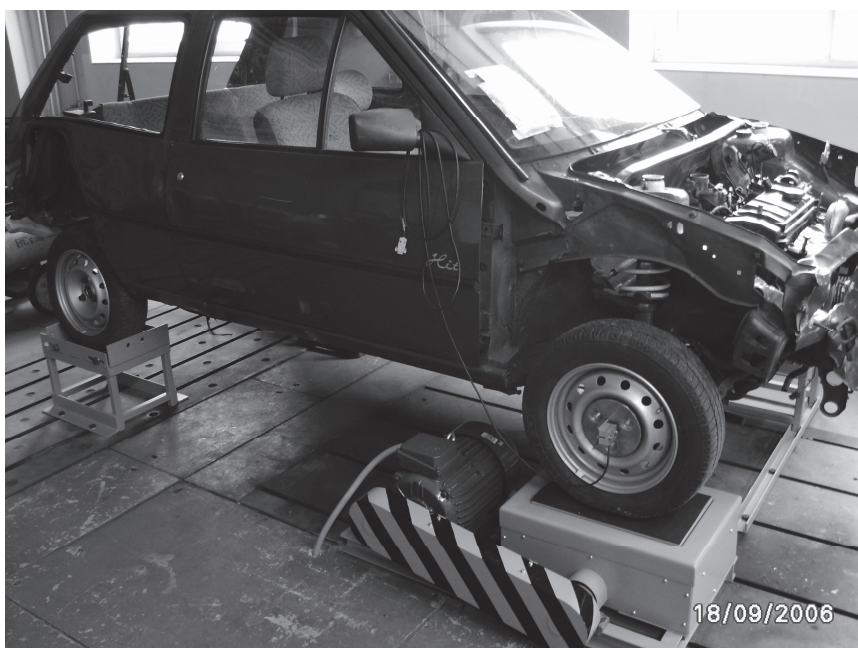
Rys. 1. Pierwsza koncepcja platformy wibracyjnej na stanowisku badawczym.
