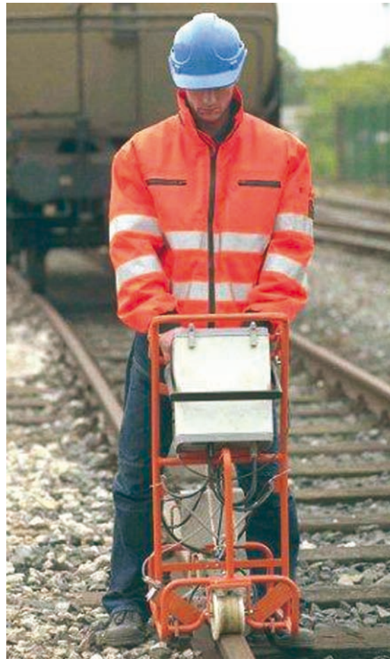
Rys. 3. Przyrząd pomiarowy stosowany w metodzie RailScan (Materiały reklamowe firmy Elektro-Thermit GmbH)
