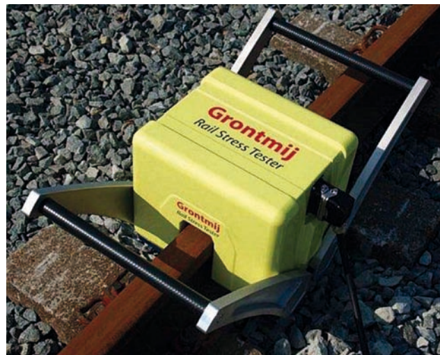
Rys. 7. Urządzenie GRONTMIJ w stanie eksploatacyjnym [23] (materiały reklamowe firmy GRONTMIJ)
