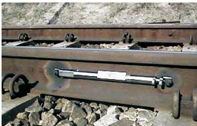
Rys. 1. Miernik sił podłużnych w szynach MS-02 [24]
