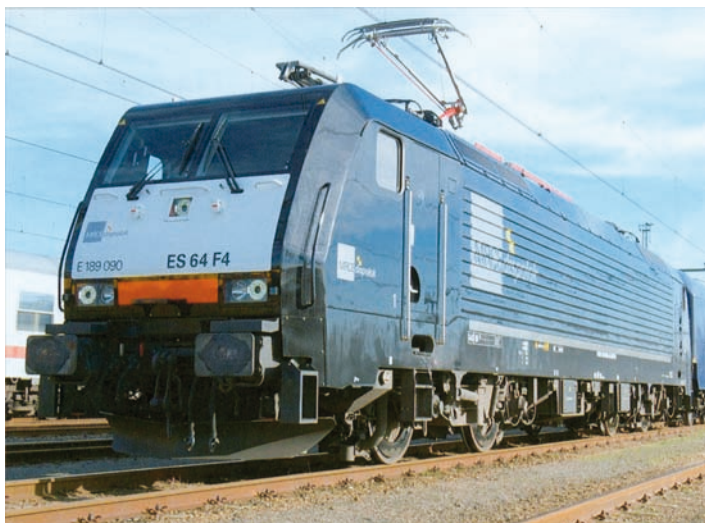
Lokomotywa typu ES 64, produkcji Siemens, własność wypożyczalni taboru MRCE, wyposażona w system Atlas 200, produkcji Alstom
