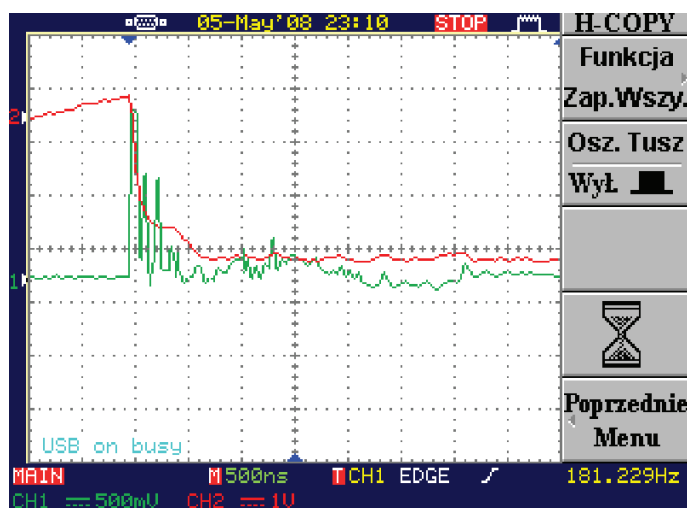
Rys. 13. Zmierzony przebieg prądu i napięcia na świecy zapłonowej. Fig. 13. Current and voltage on the spark plug.
