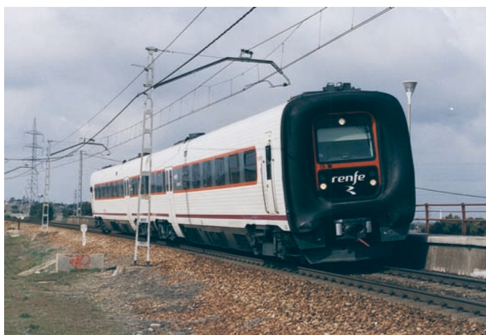
Hiszpański zespół 594-102 z mechanizmem przechyłu pudła sterowanym systemem GPS jako pociąg relacji Salamanca – Madryt (Oklica El Teraj, luty 2006 r.)
