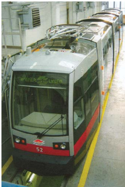
Rys. 44. Dach – kabina motorniczego i przestrzeń dla pasażerów są klimatyzowane
