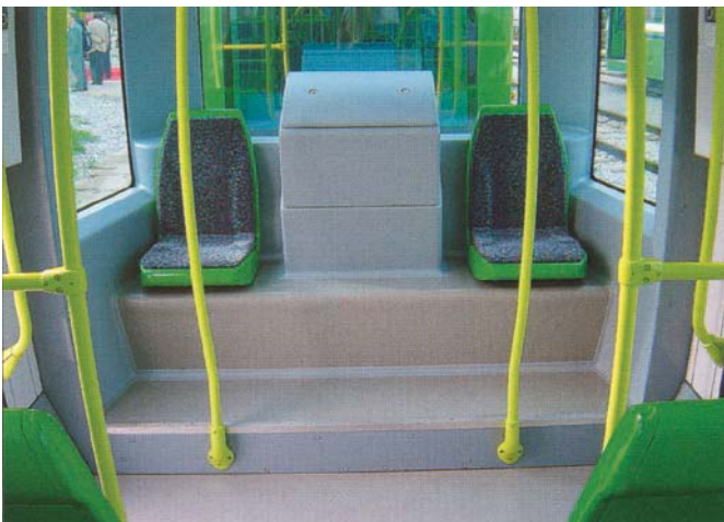
Rys. 4. Platforma tylna z pomocniczym stanowiskiem motorniczego
