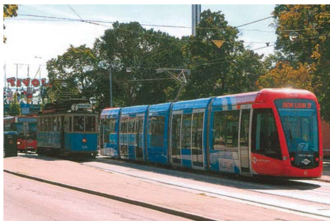
Rys. 10. Citadis 302 z Madrytu; 32,34x2,4 m, w czasie jazdy próbnej na linii Museumslinie 7 w Sztokholmie, Djurgården, sierpień 2007 r. Po lewej Tw 335, 1923, MAN/ASEA, 11,68x2,2 m, rozstaw zestawów kołowych 1300 mm, rozstaw punktów obrotu 4,4 m, średnica kół 650 mm, 4x37 kW, 20 t Fot. T. Johannson
