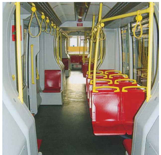
Rys. 47. Wnętrze pojazdu wykonane z materiałów niepalnych
