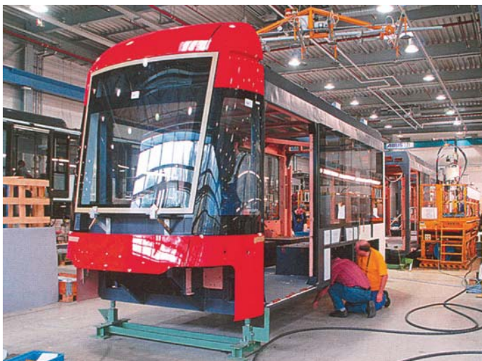
Rys. 50. Pojazd Vario dla Norymbergii na hali montażu w zakładach w Pankow Fot. VAG Norymberga
