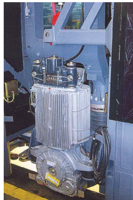
Rys. 41. Portal napędny; zamontowanie silnika, który wspiera się również poprzez sprężyny gumowe na portalu. Przekładnia napędza koło poprzez sprzęgło. Tarcza hamulcowa montowana jest na górze na silniku. Lektyka zawieszona jest na usprężynowaniu drugiego stopnia
