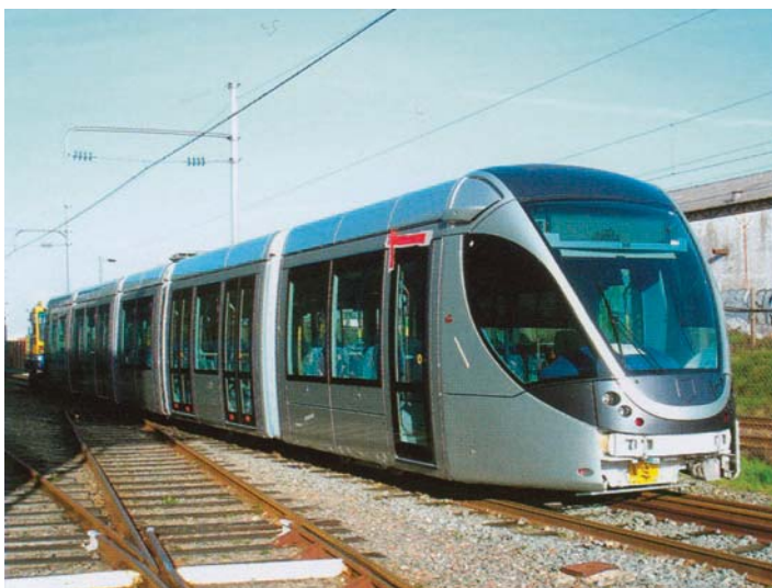
Rys. 14. Citadis 302 z napędem na wszystkie koła dla Jerozolimy, 32,52×2,65 m w La Rochelle; projekt Enthoven
