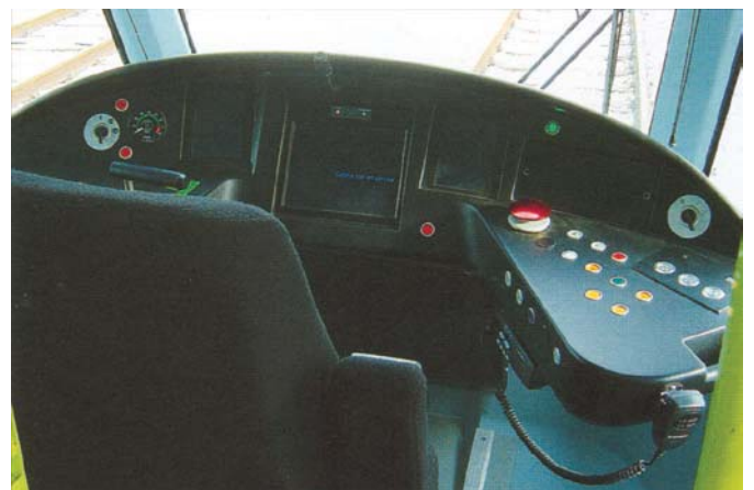
Rys. 7. Pulpit motorniczego w wykonaniu dla Tunisu; dwa monitory ekranowe zamiast lustek
