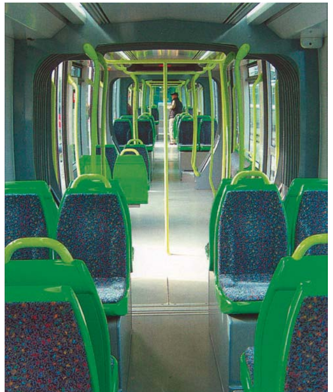
Rys. 6. Citadis 302; jak zawsze 3×16 miejsc siedzących na podestach i pojedyncze grupy siedzeń w lektkach
