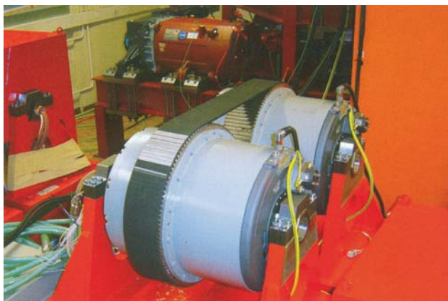
Rys. 57. Dwa silniki TSA naprzeciw siebie podczas prób obciążeniowych, ABB, Turgi. W tle silnik VEM z przekładnią firmy Flender dla pojazdu Tango
