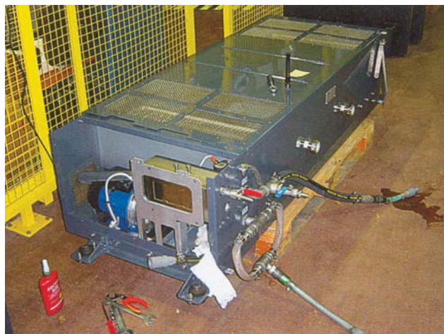
Rys. 60. Układ chłodzenia cieczą do silników i falowników produkcji ABB
