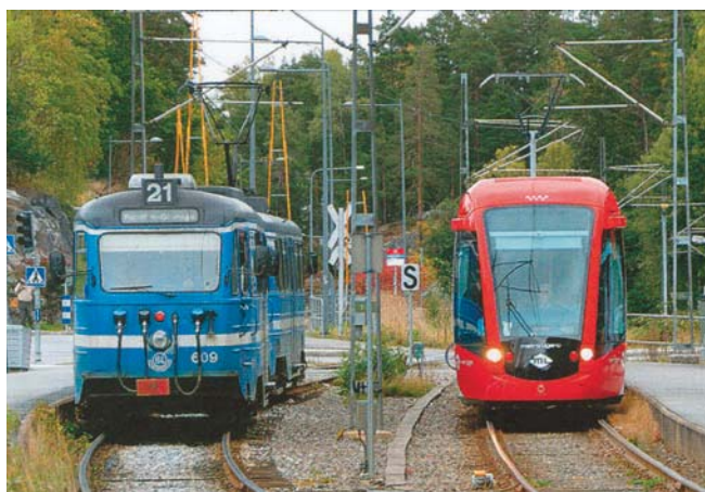
Rys. 8. B30 + A30 (dawniej B + A24) z 1944 r. i Citadis 302 z Madrytu na południowej linii Lidingöbahn 21, Kappala. Przygotowano perony dla szerokości pojazdów 2,65 m, a do pojazdu A30 dopasowano małe stopnie wejściowe Fot. T. Johannson
