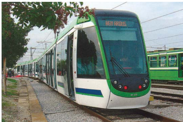
Rys. 1. Wagony sprężone tył-tył; Alstom, Citadis 302 w Tunisie w trakcji podwójnej
