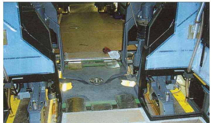
Rys. 46. Przegub kulisty między lektyką i modułem końcowym
