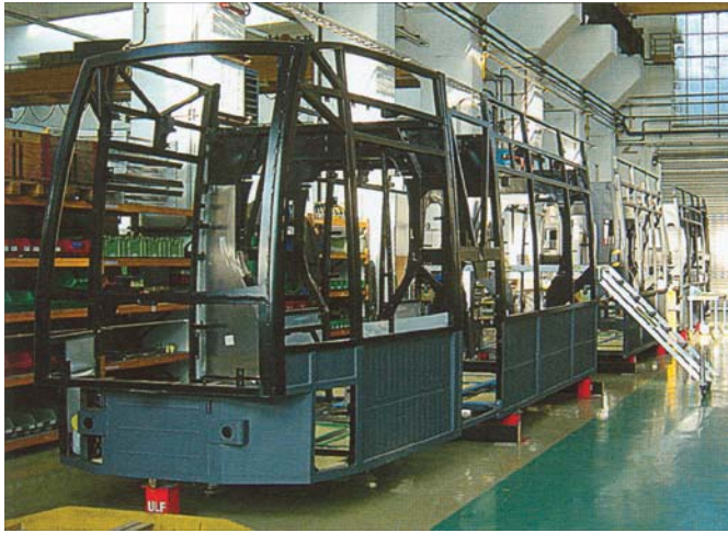
Rys. 43. Nadwozia ze stali czarnej, wytwarzane przez ÖBB w Knittelfeld
