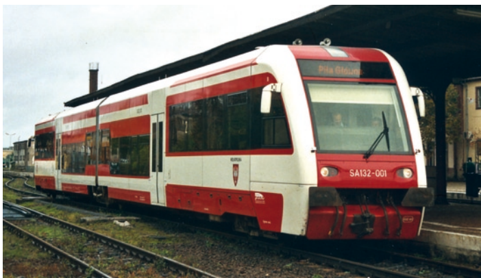
Dwuczłon z dwoma zespołami napędowymi (MTU-ZF Friedrichshafen); na zdjęciu w wersji z dwoma przedziałkami wejściowymi, dostarczonej dla województwa wielkopolskiego (218Ma)
