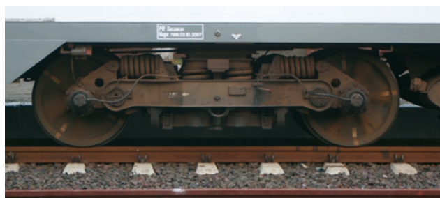
Wózek toczny wagonu SA110 z charakterystycznym wahaczowym prowadzeniem zestawów kołowych
