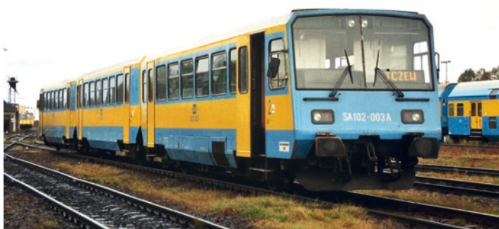
Trójczłon SA102 – wersja z dwoma wagonami silnikowymi dla „linii górskich”
