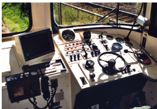
Pulpit sterowniczy niemieckiego wagonu SA110; w ciągu wielu lat eksploatacji pojazd był poddawany licznym modernizacjom
