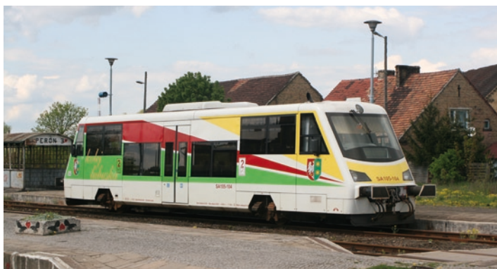
Autobus szynowy Regio Tramp produkcji ZNTK Poznań w drugim wykonaniu (213Ma) z jedną parą drzwi i typowymi urządzeniami cięgiowo-zderzakowymi, obsługujący trasę Międzyrzecz – Rzepin
