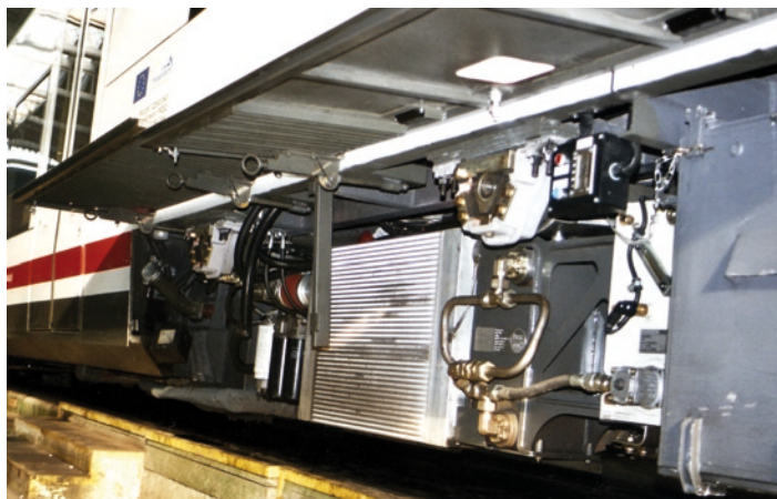
Silnik spalinowy zblokowany z przekładnią hydrodynamiczną (PESA-pack) w pojeździe SA133-001
