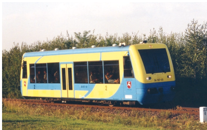
Prototyp niskopodłogowego autobusu szynowego typu 211M (SA107) wyprodukowany w Kolzami w 2003 r.; ze względu na małą pojemność zamówiono tylko dwa egzemplarze
