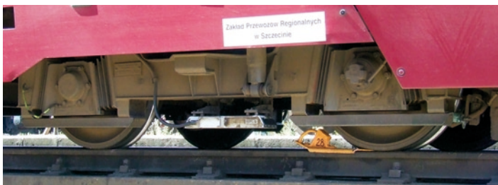
Wózek typu JBg z elementami gumowo-metalowymi w I stopniu usprężynowania standardowo stosowany do wszystkich pojazdów spalinowych budowanych dla krajowych odbiorców
