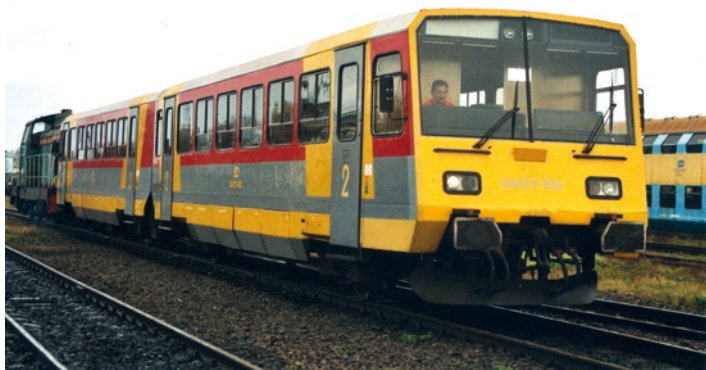
Dwuwagonowy zespół serii SA101 produkcji ZNTK Poznań; na początku lat 90. te pojazdy miały zrewolucjonizować obsługę lokalnego ruchu pasażerskiego
