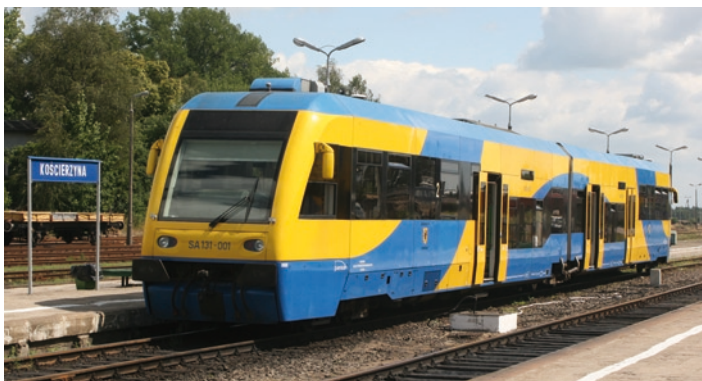
218M – pierwszy pociąg spalinowy o dużej pojemności dla 280–300 pasażerów w pierwotnym wykonaniu z jednym zespołem napędowym (Iveco-Voith), SA131-001
