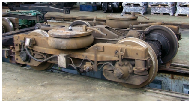
Lekka konstrukcja wózka wagonu VT628 z pneumatycznym usprężynowaniem II stopnia
