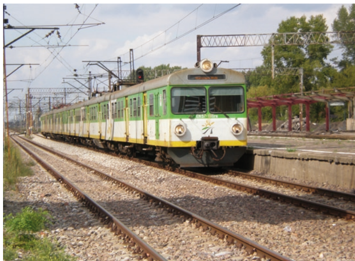
Fot. 2. Pociąg Kolei Mazowieckich przejeżdża przez układ towarowy stacji Warszawa Praga podczas modernizacji odcinka Warszawa – Nasielsk; pomimo wykonania napraw nawierzchni przez kilka miesięcy pociągi kursowały trasą objazdową z prędkością 20 km/h, zanim nie została ona zwiększona do 40 km/h
