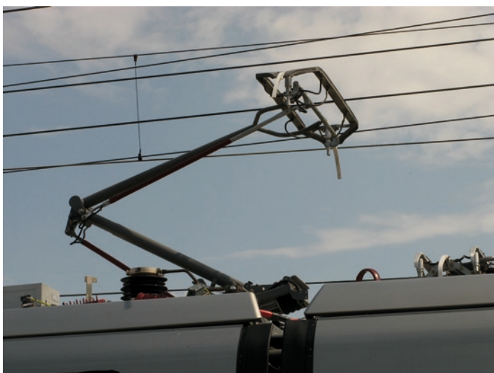
Fot. 16. Pantograf AGV – Faiveley Cx25
