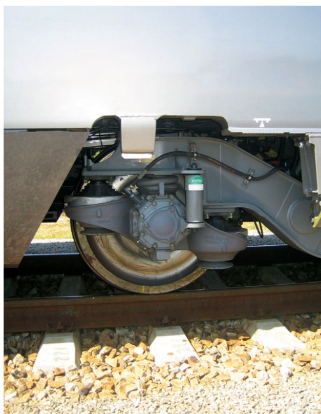
Fot. 4. Zawieszenie zestawu kołowego wózka napędnego
