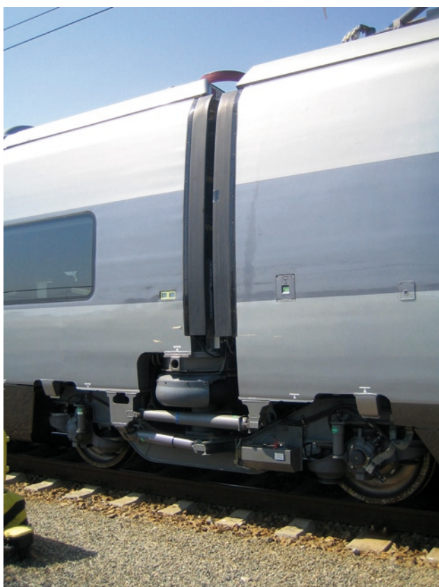
Fot. 2. Wózek toczny na połączeniu przegubowym wagonów
