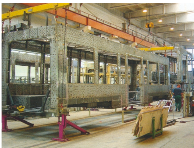
Rys. 33. Środkowy wagon ze stali nierdzewnej dla Bremy
