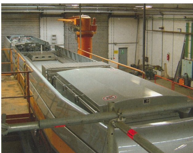
Rys. 29. Proste wyposażenie elektryczne, brak na dachu urządzeń do ogrzewania przedziału dla pasażerów i urządzenia klimatycznego
