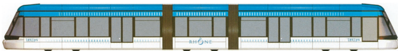
Rys. 46. Projekt Tango dla Leslys; według koncepcji obciążenie wzdłużne 600 kN, prędkość najjeżdżania (prędkość zderzenia w czasie kolizji) 20 km/h Ilustr. Departament Rhone
