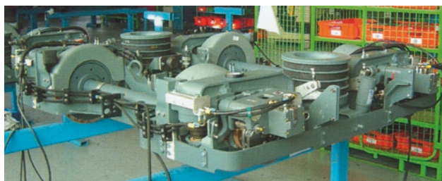
Rys. 12. Braunschweig, wózek z małymi luźnymi kołami, koła z hamulcami. Elastyczne boczne połączenia przegubowe maźnic, resory pierwotne o kształcie stożkowym ze sprężynami metalowo-gumowymi. Amortyzator wahacza składa się ze sprężyny śrubowej, połączonej szeregowo z elementami gumowymi
