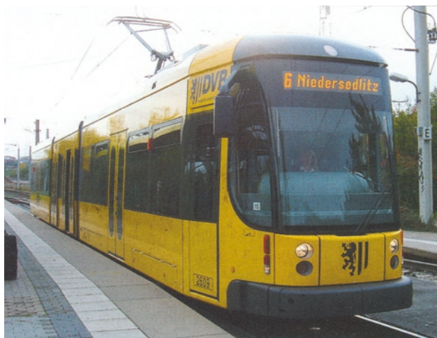
Rys. 30. Dresden NGT8DD; dwa wagony z wózkami połączone poprzez lekką tykę, trzy spośród czterech wózków napędzanych wagonu o długości 30 m z czterema drzwiami
