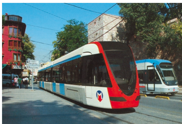
Rys. 42. Nowy Citadis 301 dla Istanbulu z trzema wózkami z osiami ciągowymi Fot. Alstom
