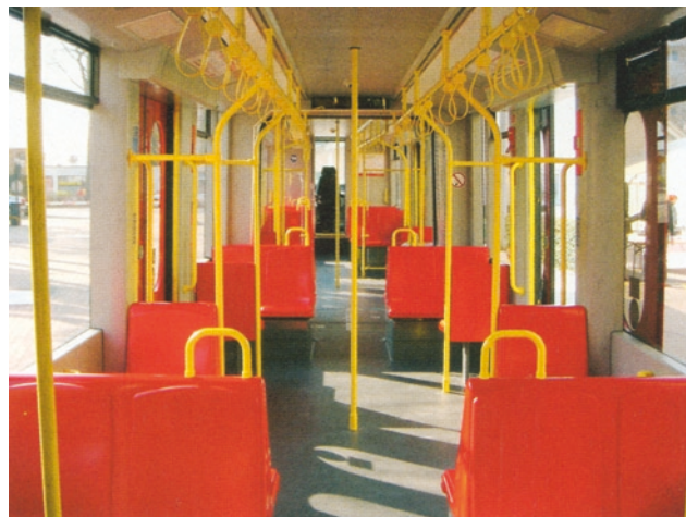
Rys. 45. U6 – widok z wagonu środkowego do przodu; przejście po rampie, szerokości 440–530 mm, w części wagonu nad wózkami napędzonymi
