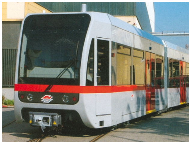
Rys. 44. Pierwszy Wierne (Wiedeńczyk) U6 najnowszej generacji, nr 2679, w zakładach Bombardiera w Wiedniu; wymiary: 26,8×2,65 m
