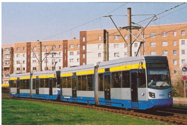
Rys. 23. Dwa pojazdy Leoliner zastępują w trakcji wielokrotnej pojazdy złożone z T4+T4+B4 Fot. Alstom
