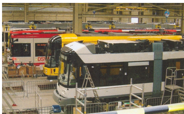
Rys. 2. Widok hali montażu końcowego, Bombardier, Budziszyn; parada pojazdów tzw. 70%-niskopodłogowych; Hermelin z De Lijn – pięćczęściowy, wieloprzegubowy pojazd ze stałymi wózkami, ostatnie 20 wagonów otrzyma ponownie przednie drzwi wejściowe; na drugim planie Dresden DD8 – trzyczęściowy 30-metrowy pojazd typu Classic Sachsen na czterech wózkach, dwa wagony motorowe i jedna lektyka, a za nim trzyczęściowy pojazd dla DSW21, Dortmund – również na czterech wózkach, jeden wagon środkowy, na którym spoczywa wagon końcowy
