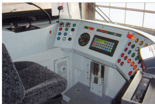
Rys. 19. Kabina motorniczego, przystosowana do sprzedaży biletów
