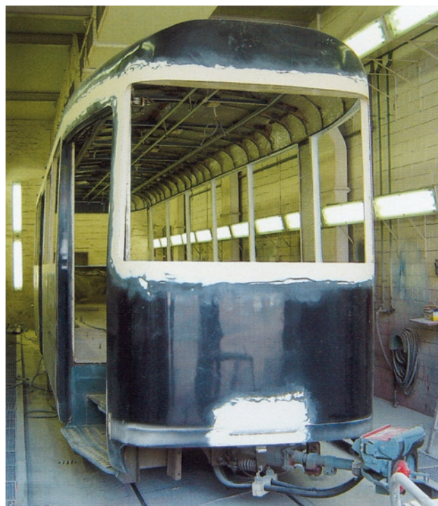
Rys. 20. Duewag, wagon doczepny z 1994 r. przerobiony dla pojazdu NGT8D
