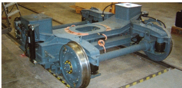
Rys. 24. Leoliner – wózek toczny, hamulce
