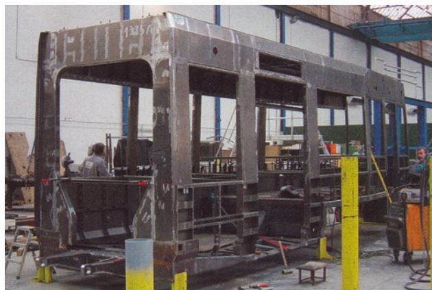
Rys. 26. Leoliner – pudło wagonu końcowego dla LVB (w budowie). Wbudowany przegub kulowy między częściami wagonu
