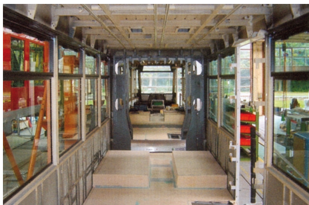
Rys. 10. Wnętrze tramwaju Braunschweig; proszę zwrócić uwagę na wewnętrzną kół, konieczne dla wychylenia wózków na zakrętach
