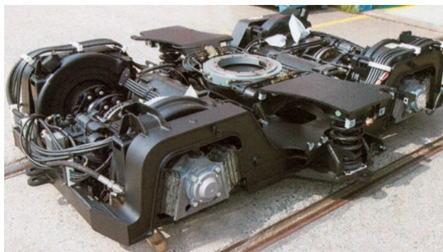
Rys. 11. Wózek napędny tramwaju Gera. Wahacz poprzez wzdłużną prowadnicę połączony jest z ramą wózka (na zdjęciu niewidoczne), pionowe amortyzatory nie są jeszcze zamontowane. Silniki chłodzone wodą. Resorowanie osi typu Megi Fot. Alstom
