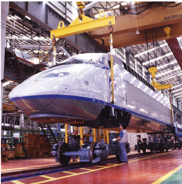
Montaż wagonu silnikowego w fabryce w Korei Płd.
