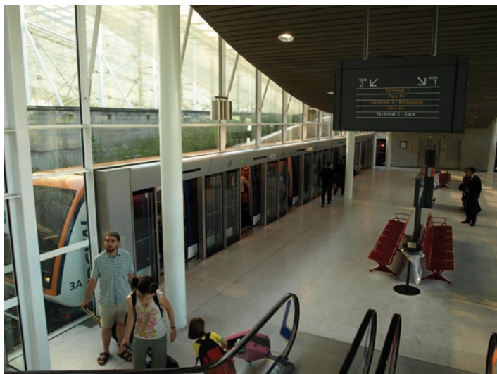
Jedna ze stacji CDG Val. Pojazd od peronów oddzielają szklane drzwi otwierające się automatycznie po zatrzymaniu pojazdu. Powyżej drzwi o szerszym wejściu znajduje się oznakowanie wejścia dla niepełnosprawnych
