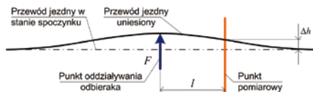
Rys. 1. Metoda pośrednia pomiaru siły nacisku odbieraka na przewód jezdny
