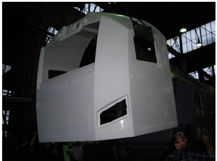
Fot. 4. Laminatowe poszycie kabiny maszynisty
