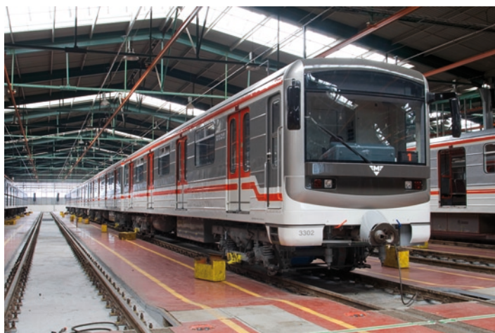
Fot. 9. Zespół serii 81-71M (81-71BARS – dla linii B z ARS) 3302-3322 w lokomotywowni Hostivař oczekujący na instalację systemu ARS. (17.3.2006)
