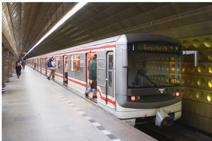
Fot. 5. Zespół 81-71 (2121-2131) na linii B na stacji Florenc. Widoczne są tymczasowe stacyjne lampy oświetleniowe, zainstalowane po rekonstrukcji stacji po powodzi w 2002 r. (5.1.2006) Fot. Bohuslav Kotla
