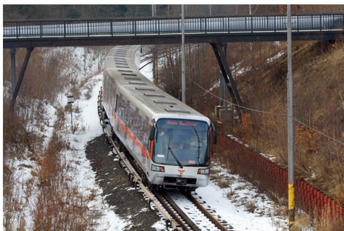
Fot. 7. Zespół M1 na torze testowym lokomotywni Hostivař w trakcie testowania jego systemu PA-135 ATC/ATO (17.3.2006)
