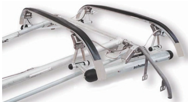
Rys. 6. Ślizgacz i rama górna pantografu do 400 km/h firmy Schunk
