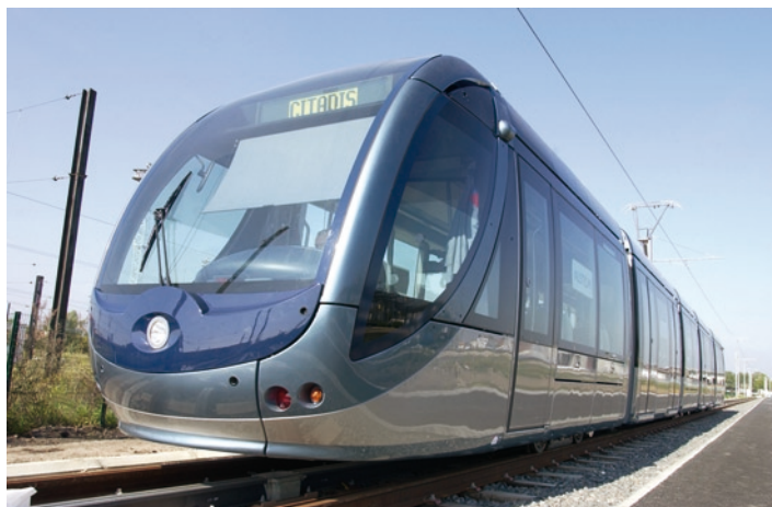
Fot. 6. Citadis w Bordeaux z systemem APS
