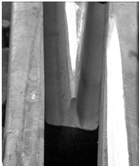
Rys. 16. Krzyżownica z wymiarem f = 1388,1 mm; prawdopodobna wartość zaczepienia koła wynosi 3,9 mm, zupełny brak śladów współpracy końca dzioba z kołem na długości ok. 45 mm, przeważający ruch po torze zasadniczym, prędkość maksymalna 120 km/h
