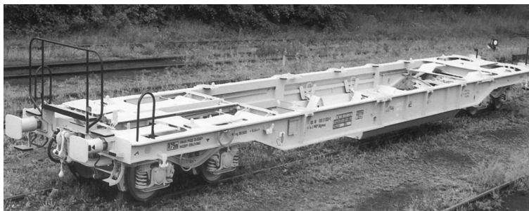
Rys. 3. Wagon kieszeniowy do przewozu kontenerów, naczip wymiennych i naczip siodłowych
