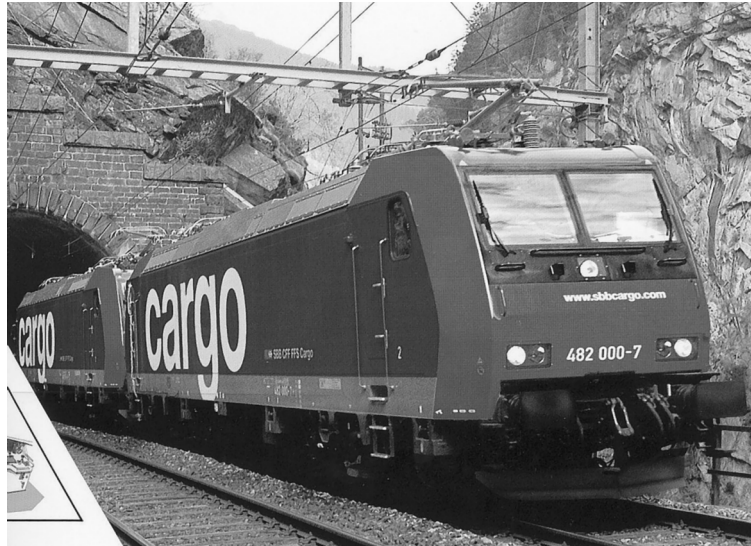
Rys. 2. Nowoczesny, kolejowy tabor trakcyjny do przewozów towarowych. Lokomotywa elektryczna wielosystemowa dużej mocy, z serii TEAXX firmy Bombardier
