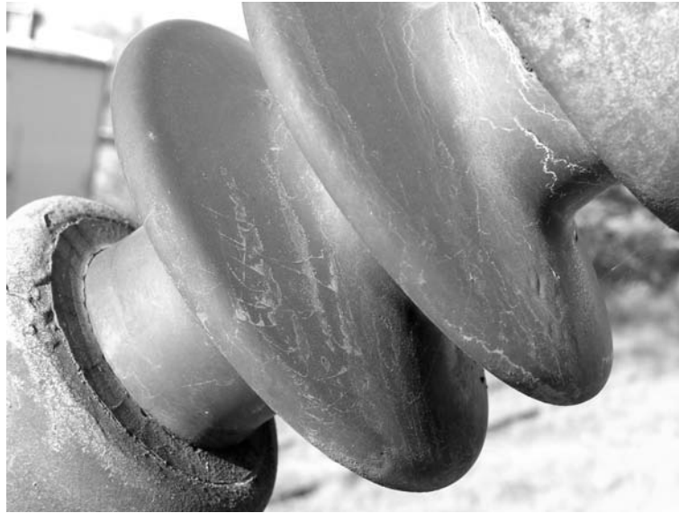
Rys. 11. Izolator ukośnika o znacznych zmianach koloru szkliwa
