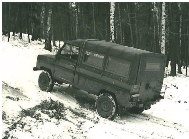
Rys. 14. Samochód Tarpan HONKER z mechanizmami różnicowymi MR.04a i MMR.04 w czasie prób terenowych w okolicach Bielska-Białej.
