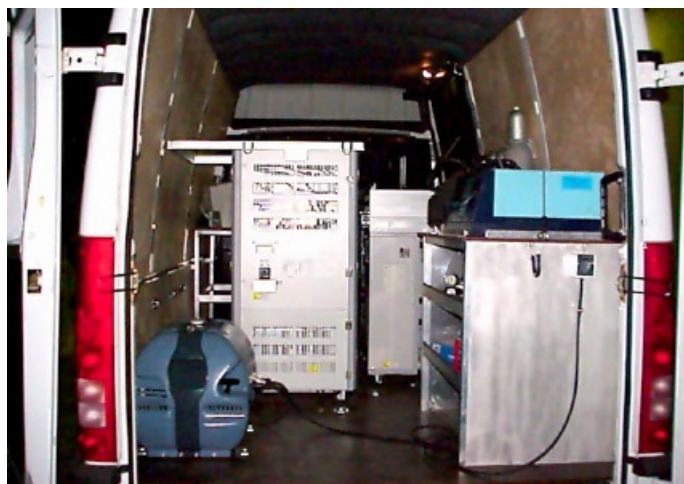
Rys. 11. Rozmieszczenie analizatorów w mobilnym laboratorium
