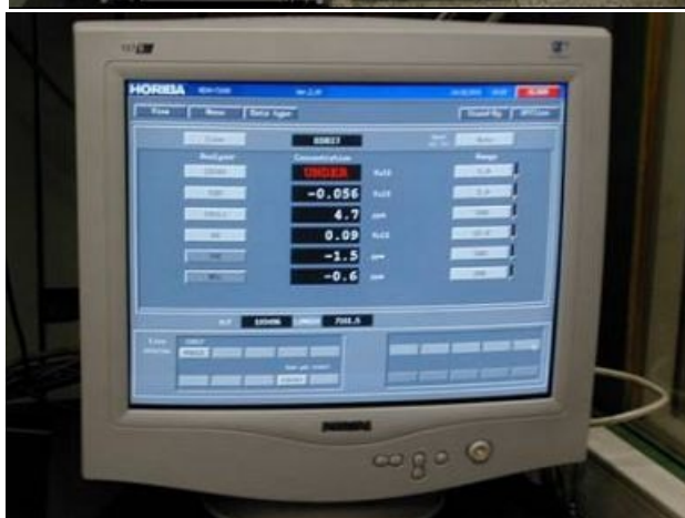
Rys. 5. Aparatura badawcza systemu Mexa 7100D firmy Horiba
