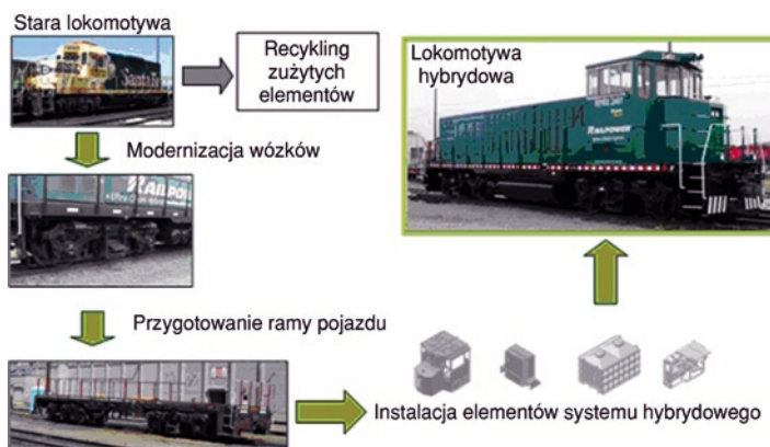
Rys. 6. Proces modernizacji klasycznej lokomotywy na lokomotywę hybrydową [1]
