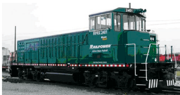
Fot. 1. Lokomotywa hybrydowa GG20B w technologii Railpower [1]
