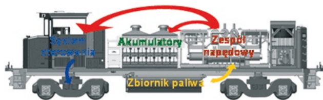
Rys. 1. Idea działania napędu hybrydowego konstrukcji Railpower Technologies Corp. [1]
