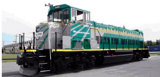
Fot. 2. Lokomotywa hybrydowa RP20BH w technologii Railpower [1]
