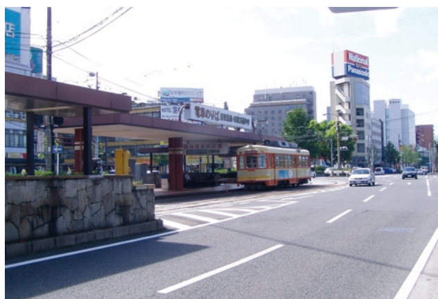
Rys. 12. Matsuyama – na jeden z przystanków przed dworcem JR Matsuyama można się dostać tylko przejściem podziemnym, na drugi (poza kadrem z lewej) wiedzie dodatkowo przejście pasami, ale na drugim końcu peronu; najwyraźniej chciano usunąć ruch pieszy z widocznego w głębi skrzyżowania
