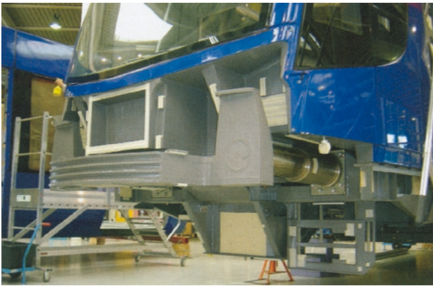
Fot. 18. Avanto; zderzak przedni, zgodnie z DIN 5560
