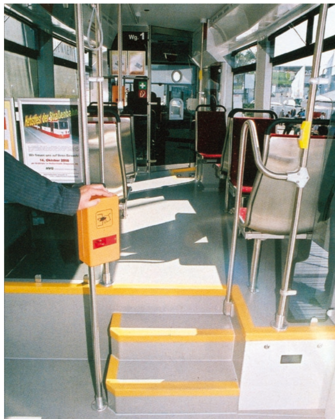
Fot. 7. Leoliner, Halberstadt; widok przedniej części wysokopodłogowej
