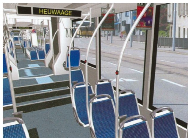
Fot. 24. Tango; wnętrze nad wózkiem Jakobsa
