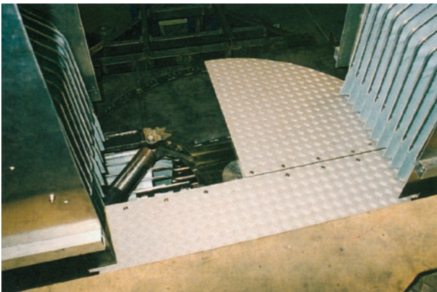
Fot. 19. Avanto; przegub firmy Hübner z tłumikami
