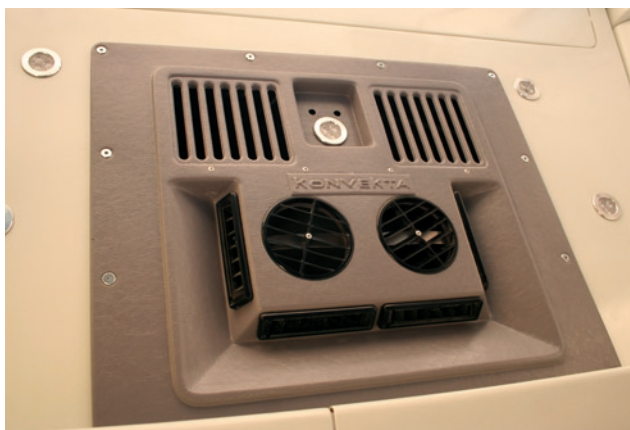
Fot. 20. Klimatyzacja kabiny motorniczego firmy Konvekta w wagonie 120N; 16.07.2007 r. Fot. K. Lipnik
