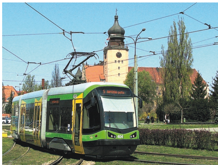
Fot. 17. 121N 404 na Grobli św. Jerzego. Futurystyczny kształt nadaje pesom między innymi pantograf półkowy zamontowany „pod włos”; 26.04.2007 r.
