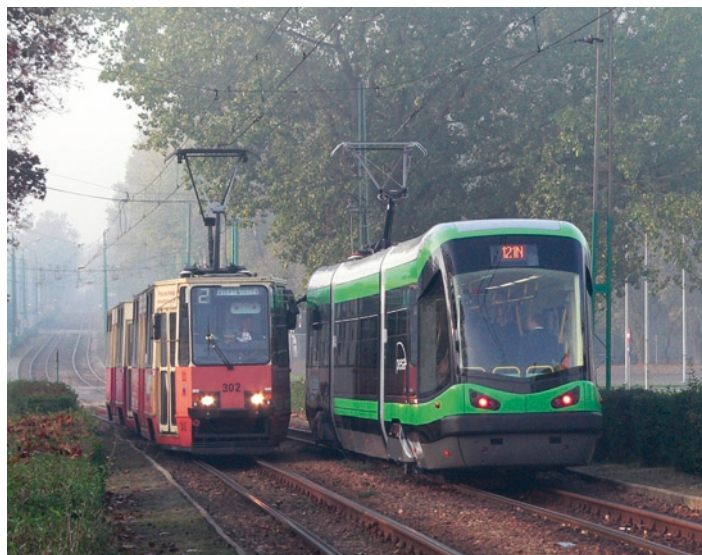
Fot. 13. Wagony z PESY mają nominalną szerokość podła 2350 mm, która jednak w obrębie ostoi wózków wynosi 2400 mm, czyli polski standard; w drodze z Leśnego Parku Kultury i Wypoczynku wagon niskopodłogowy minął się z klasycznym zestawem bydgoskich 805Na, demonstrując swą niezaprzeczalną stylistyczną wyższość; 20.10.2007 r.
