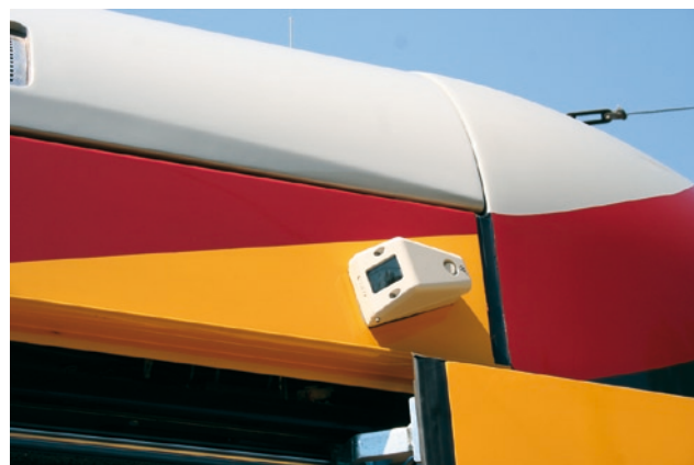
Fot. 19. Zamiast lusterek zewnętrznych, pesa 120N wyposażona jest w kamery; 16.07.2007 r.
