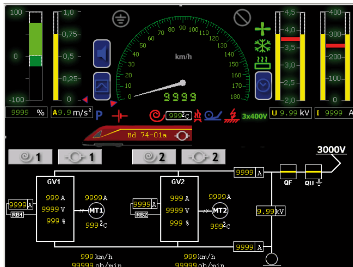
Rys. 8. Przykład ekranu na wyświetlaczu stanowiska maszynisty – wyświetlane informacje trakcyjne z pierwszego członu napędowego
