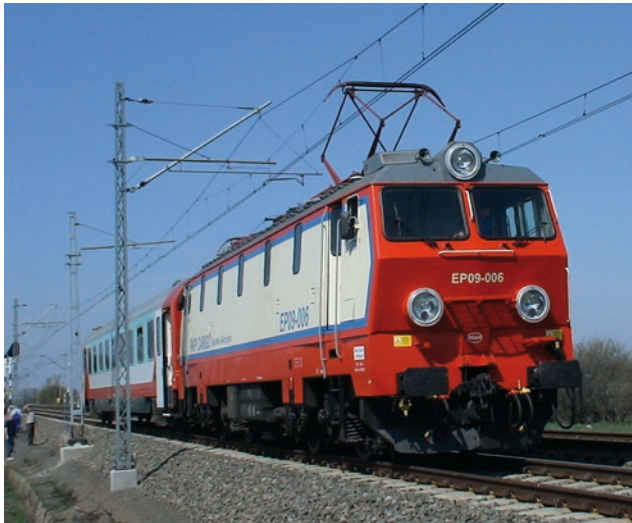
Rys. 16 Testowanie nowego typu sieci na odcinku doświadczalnym Żychlin-Stara Wieś. Jednostka pomiarowa wraz z lokomotywą EP09-006
