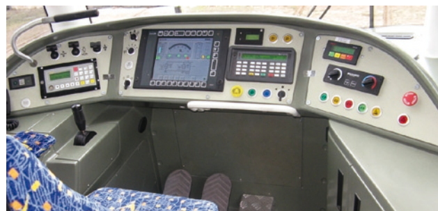
Fot. 3. Pulpit motorniczego tramwaju typu 120N (fot. PESA)
