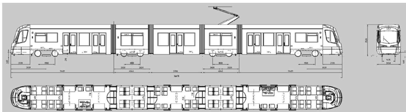
Rys. 3. Schemat pojazdu dwusystemowego Avanto linii T4
