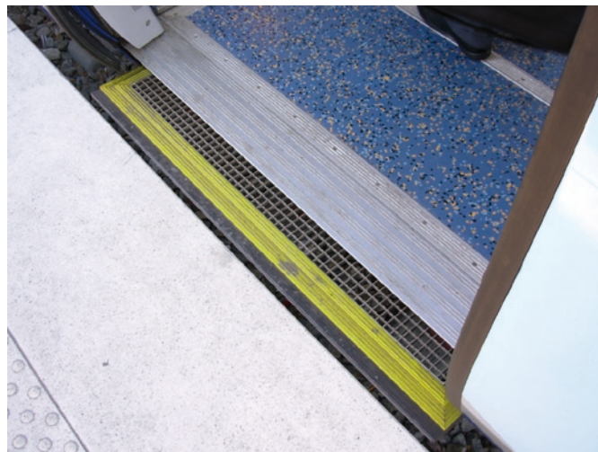
Fot. 20. Linia T4 – ze względu na większą skrajnię kolejową, pojazd jest wyposażony dodatkowo w wysuwane przedłużenie stopnia dla zminimalizowania szczeliny między pojazdem i peronem
