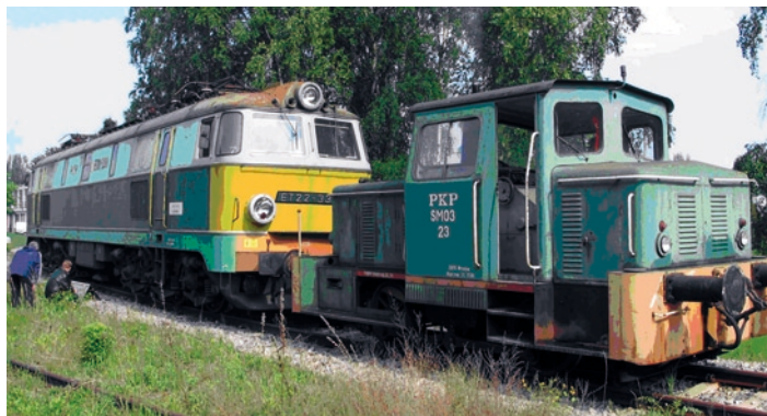
Fot. 2. Lokomotywa ET22-334 podczas pomiarów wykonywanych przez CNTK Warszawa na torze tensometrycznym spełniającym uwarunkowania określone w ORE B55 RP8 oraz lokomotywa SM03 spełniająca rolę lokomotywy napędowej (badania wykonywane w CNTK Warszawa)
