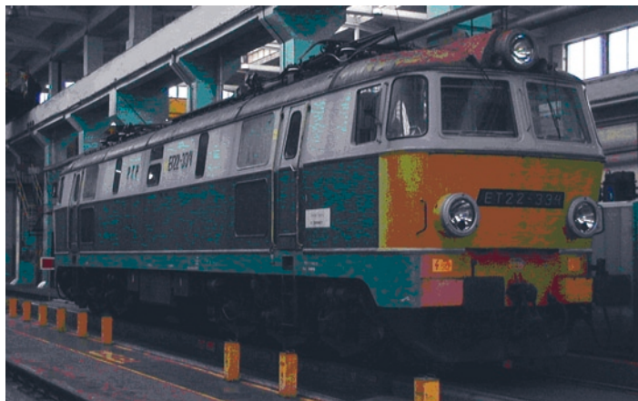
Fot. 1. Lokomotywa ET22-334 podczas pomiarów wykonywanych przez CNTK Warszawa w Zakładzie Taboru w Krakowie – na stanowisku TENSAN
