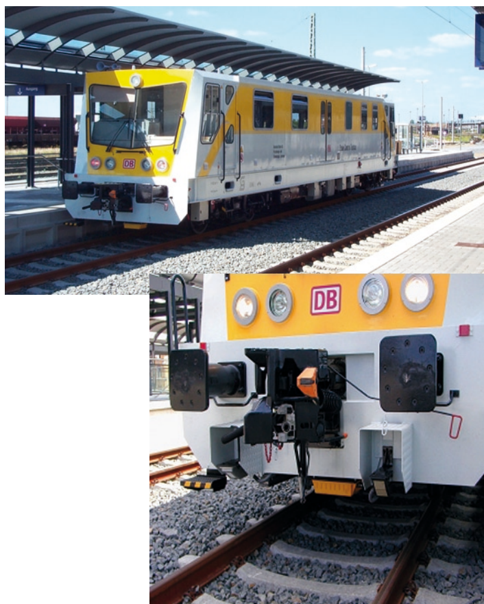
Rys. 17. Spalinowy pociąg dojazd kontrolnych TCT [1]
