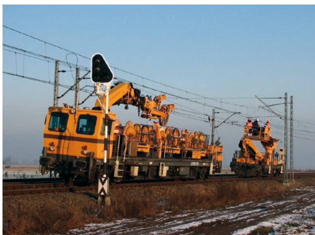
Rys. 9. Pojazd służący do rozwieszania lin nośnych oraz przewodów jezdnych po ich naprężeniu
