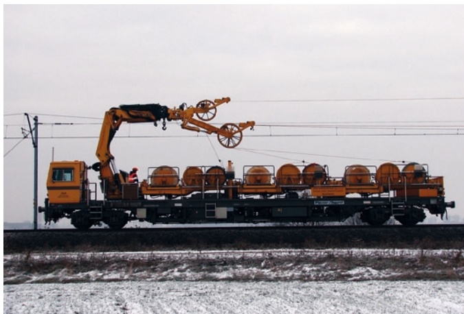
Rys. 9. Pojazd służący do rozwieszania lin nośnych oraz przewodów jezdnych po ich naprężeniu
