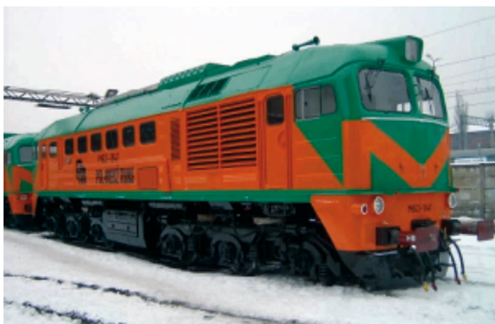
Rys. 1. Zmodernizowana lokomotywa M62 z silnikiem 12 CzN 26/26
