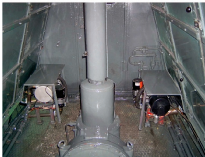
Rys. 10. Zabudowa podgrzewacza płynu chłodzącego Webasto
