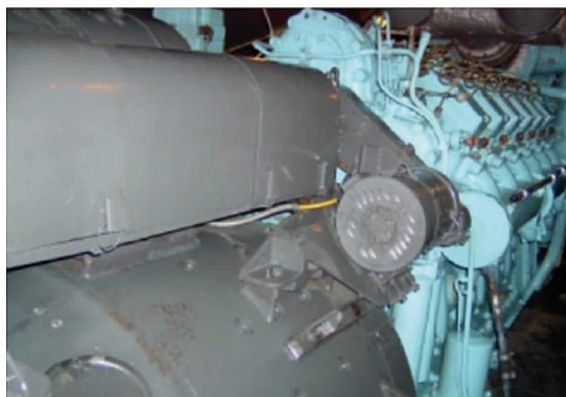
Rys. 5. Widok na zespół prądowłóczy zabudowany we wnętrzu lokomotywy a - silnik spalinowy z przodu, b - prądnica główna i napędy pomocnicze, c - prądnica główna i silnik spalinowy
