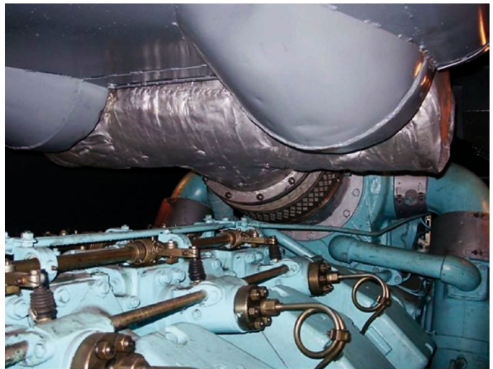
Rys. 7. Zabudowa filtra oleju firmy Boll – Kirch we wnętrzu lokomotywy
