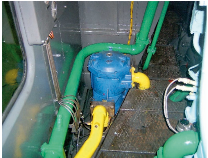
Rys. 7. Zabudowa filtra oleju firmy Boll – Kirch we wnętrzu lokomotywy
