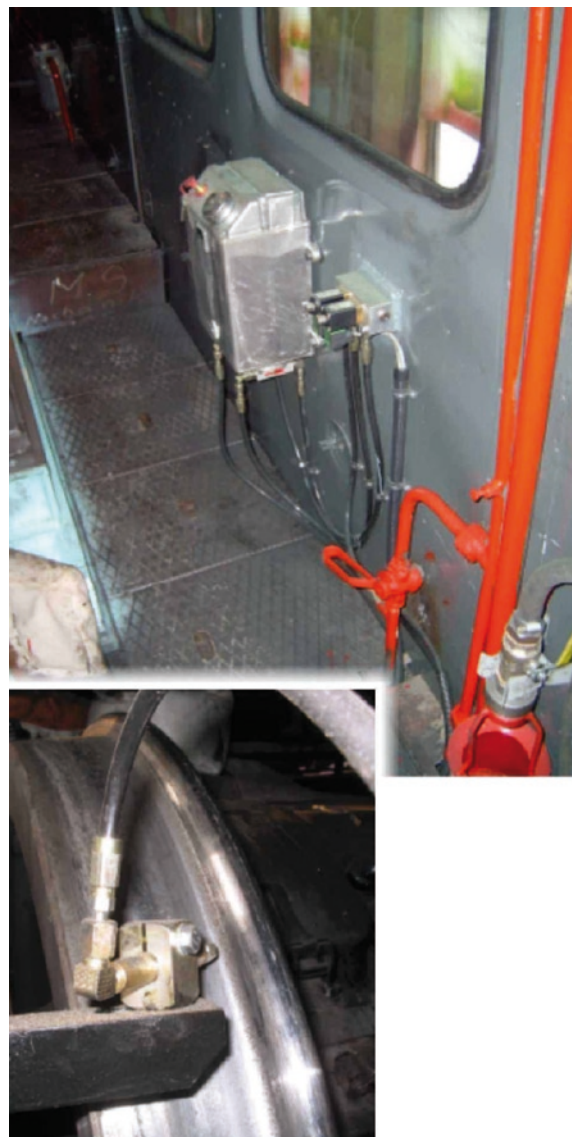
Rys. 17. Urządzenia układu smarowania obrzeży kół a - zbiornik oleju i urządzenie sterujące, b - dysza rozpylająca
