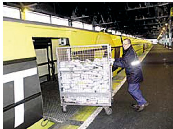
Fot. 7. Załadunek kontenera CP 820N do składu TGV La Poste [44]
