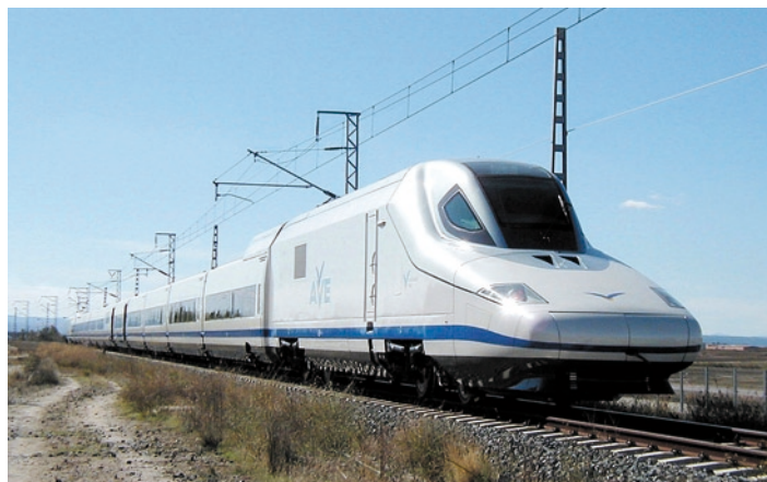
Fot. 1. Pociąg RENFE Talgo 350
