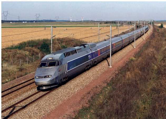
Fot. 2. TGV Atlantique w odróżnieniu od TGV PSE ma nieco zmieniony, bardziej opływowy kształt jednostki napędowej. TGV Atlantique 398 na północnej linii LGV (październik 2004 r.) Fot. M. Knappe
