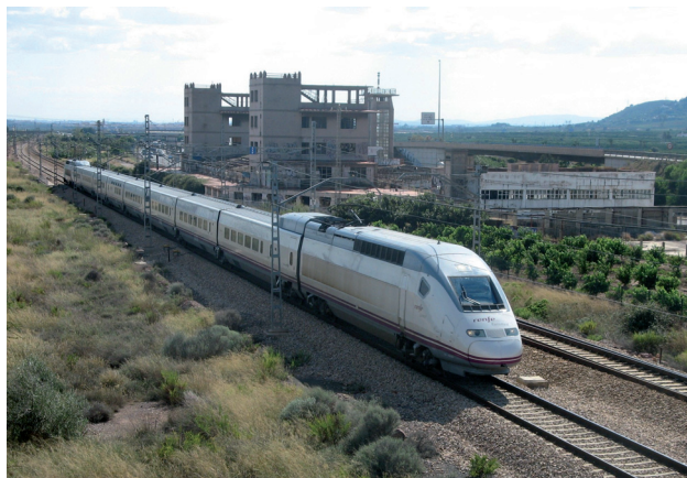
Fot. 3. Hiszpański pociąg TGV 101 001 Euromed w okolicy Sagunto; w odróżnieniu od poprzednich pociągów zastosowano nową jednostkę napędową z pociągu TGV Thalys PBKA (15.09.2006 r.) Fot. J. Pena
