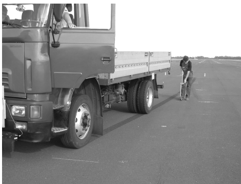
Rys. 2. Pomiar długości śladu hamowania samochodu ciężarowego za pomocą wózka pomiarowego.
