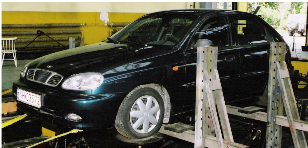
Rys.4. Samochód podczas badań na symulatorze drogi. Fig. 4. Car during the test on the road simulator.
