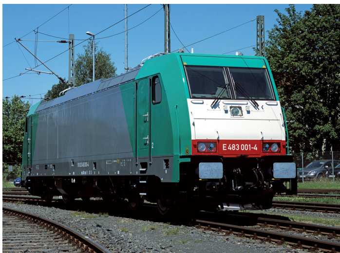
Rys. 11. Lokomotywa TRAXX DC przeznaczona do eksploatacji na liniach 3 kV DC we Włoszech
