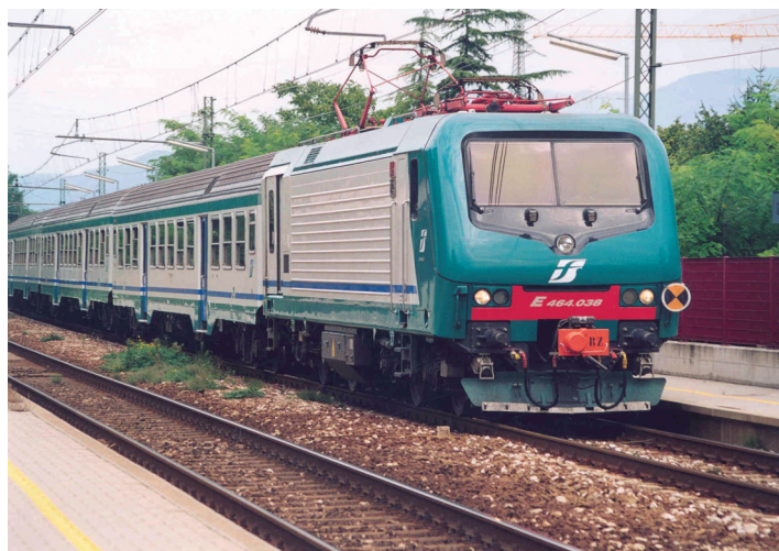
Rys. 2. Włoska lokomotywa E 464 jest przeznaczona do eksploatacji w sieci 3 kV DC Trenitalia Regional Division. Takie lokomotywy są eksploatowane w systemie push-pull w pociągach składających się z wagonów zwykłych i piętrowych. Dotychczas sprzedano ponad 388 szt. przeznaczonych do obsługi regionalnych pociągów osobowych
