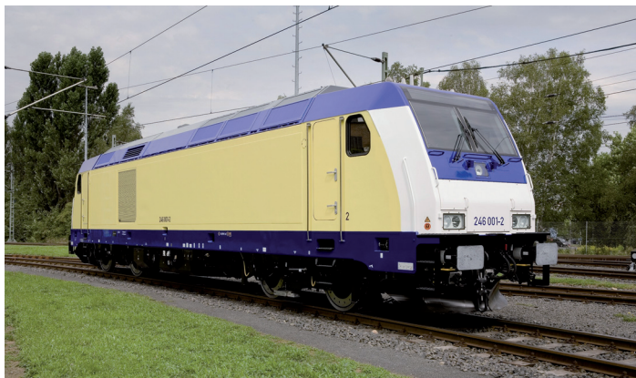
Rys. 10. Lokomotywa TRAXX DE przeznaczona dla LNVG będzie pracowała w systemie push-pull w pociągach osobowych składających się z wagonów piętrowych i poruszających się z prędkością do 160 km/h
