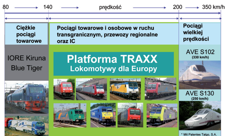
Rys. 1. Podział lokomotyw dużej mocy na trzy grupy: lokomotywy przeznaczone do przewozów towarowych, osobowych i obsługi pociągów dużych prędkości
