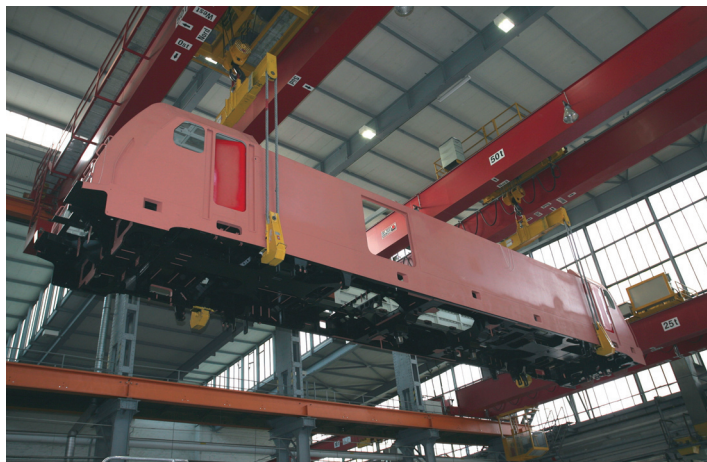
Rys. 6. Pudło nowych lokomotyw elektrycznych i spalinowych TRAXX jest identyczne, zgodnie z nową europejską normą prEN 15227 w zakresie pochłaniania energii zderzenia; konstrukcja ta została zweryfikowana i potwierdzona podczas testów zderzeniowych przeprowadzonych w centrum CNTK w Żmigrodzie; wszystkie pudła lokomotyw TRAXX budowane są w fabryce Bombardiera we Wrocławiu
