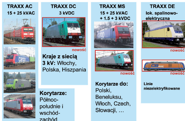
Rys. 3. Platforma TRAXX obejmuje wersje AC (15 i 25 kV AC), MS (15 i 25 kV AC + 1,5 i 3 kV DC), DC (3 kV DC) oraz DE (spalinowo-elektryczna)
