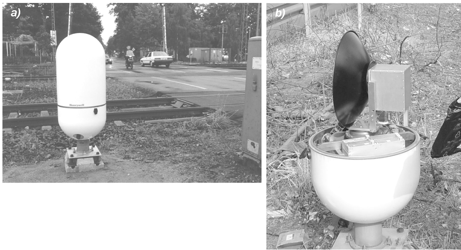
Rys. 10. Skaner radarowy a) na przejeździe kolejowym, b) widok wewnętrzny
