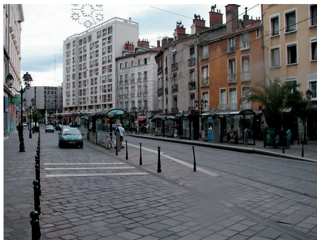
Fot. 19. Grenoble, przystanek na Place Ste-Claire. Przystanek w strefie ruchu uspokojonego śródmieścia. Tam, gdzie mogą pojawić się przechodzący zastosowano kamienne progi w jezdni
