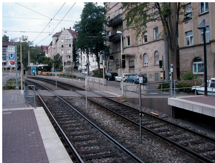
Fot. 16. Stuttgart, przejście przez torowisko przy przystanku Vogelsang. W oddali końcowy przystanek autobusu. Gdyby nie było konieczności stosowania ramp na perony, droga przesiadania mogłaby być znacznie krótsza Fot. autora, 2003
