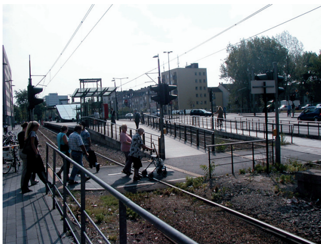
Fot. 2. Kolonia, górny peron przystanku Wiener Platz. Tutaj zastosowano peron wyspowy, bo wszystkie wagony Stadtbahn są dwukierunkowe. Pozwolił on na budowę tylko jednej windy łączącej przystanek w poziomie ulicy z przystankiem podziemnym Fot. autora, 2003
