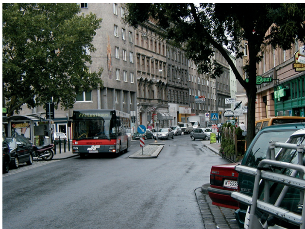
Fot. 26. Wiedeń – Kardinal-Naglplatz. Przystanek autobusowy z rozgraniczeniem jezdni w strefie ruchu uspokojonego Fot. autora, 2003
