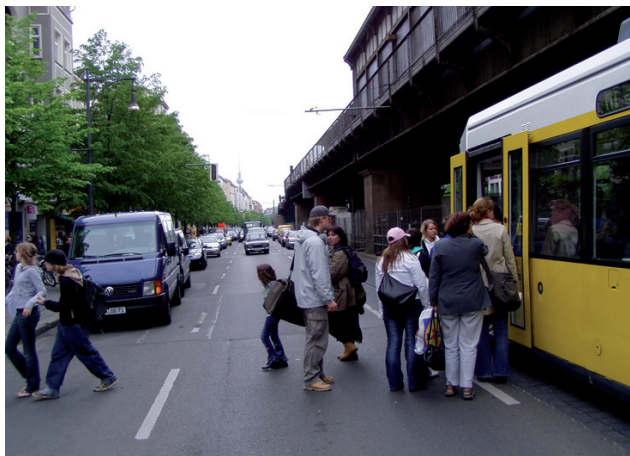
Fot. 22. Berlin, Schönhauser Allee – jedna z głównych arterii radialnych dzielnic północnych. Sygnalizacja uwalniająca od samochodów strefę przystanku, wzbudzana przez tramwaj. Samochody zatrzymały się w znacznej odległości (pas po lewej zajmują pojazdy zaparkowane) Fot. autora, 2005
