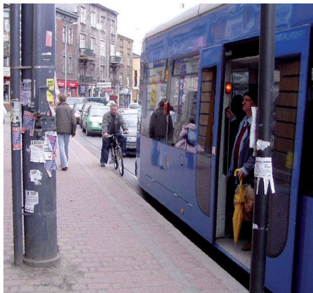
Fot. 9. Kraków – ulica Kalwaryjska. Peron wysuniętego chodnika znajduje się nieco niżej od podłogi wagonu Fot. autora, 2006
