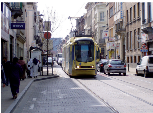
Fot. 32. Bruksela – Schaerbeek, Chaussée de Haecht. Przystanek niby podobny, ale dlaczego pozostawiono sporą odległość między krawężnikiem a wagonem – nie bardzo wiadomo Fot. autora, 2006
