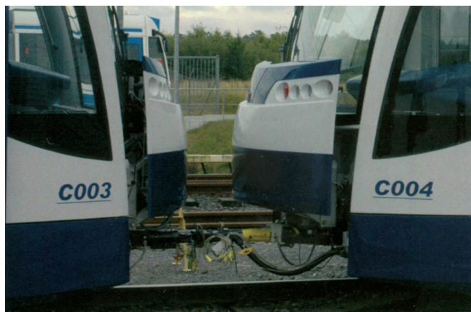
Rys. 41. Dwa GT8N mogą jeździć sprężnięte poprzez sprzęg Alberta
