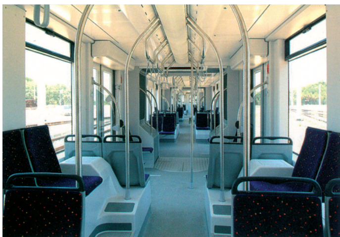
Rys. 44. GT8N, przestronne wnętrze pojazdu; szerokość przejścia wynosi 660 mm, przegubu – 1240 mm
