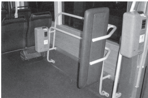
Rys. 30. Tram 3001, miejsce na wózek inwalidzki; ciekawostką jest ogrzewanie zamontowane pod siedzeniem
