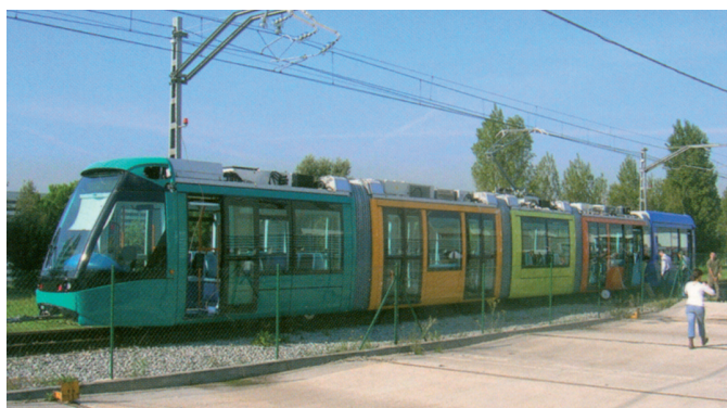
Rys. 14. Teneryfa, Citadis 302 z napędem na wszystkie koła; próby w Santa Perpetua de Mogoda (Barcelona); pojazd 18.11.2005 r. został przetransportowany statkiem do Teneryfy
