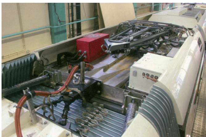
Rys. 19. Siro, przegub płaski z dwoma tłumikami wzdłużnymi
