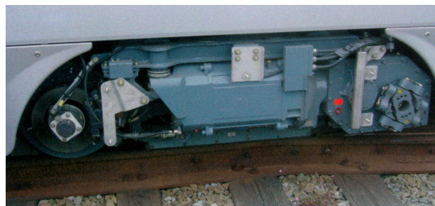
Rys. 26. Cityrunner; podwozie napędne – po lewej tarcza hamulca, po prawej sprzęg Kardena
