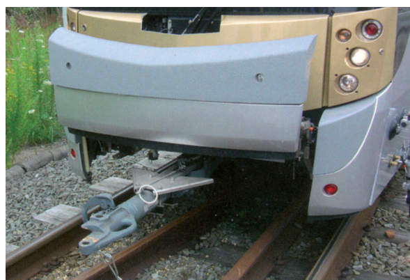
Rys. 24. Cityrunner; osłona przednia składana do góry oraz sprzęg Alberta
