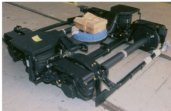
Rys. 17. Citadis 403; wózek z małymi kołami, wykonany przez Alstom-LHB
