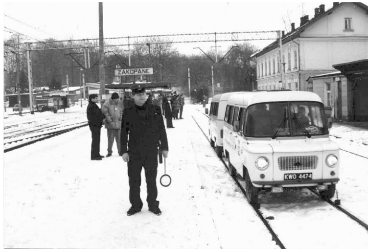
Rys. 1. Przykład prototypowego minibusu szynowego — dwa samochody marki Nysa, złączone tyłami (fot. Andrzej Massel)
