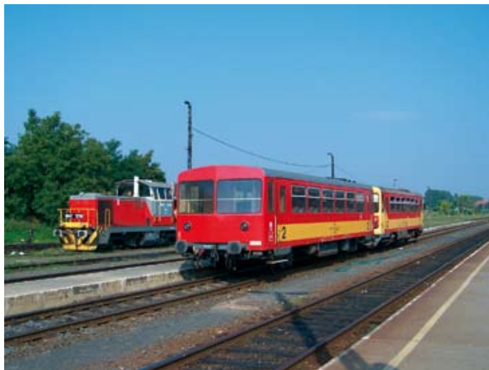
Węgry – ruch regionalny na liniach o małej frekwencji prowadzą autobusy szynowe zakupione w Czechosłowacji w latach 70. Pociąg zestawiony z Bzx532 + Bzmot180 na stacji Tapolca (2.09.2005 r.) Fot. R. Rusak
