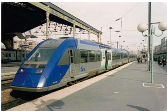
Spalinowy, 3-wagonowy zespół trakcyjny X 72500, w obsłudze połączeń regionalnych w regionie Centre Francja
