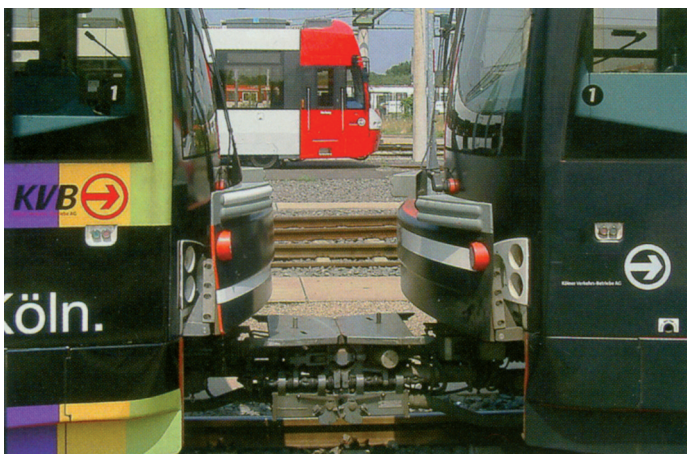
Rys. 32. Wagon K4500, jeszcze nie zmodernizowane sprzęgi; na pionowej płaszczyźnie każdorazowo montowany jest zderzak, aby również tutaj zmniejszyć przejście do 260 mm
