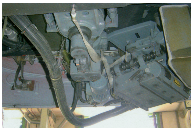
Rys. 29. Wagon K4500; elektrycznie sterowane sprzęgło BSI
