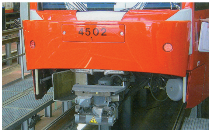
Rys. 30. Wagon K4500, przy sprzęganiu dwóch jednostek pozostaje 260 mm między płaszczyznami pionowymi
