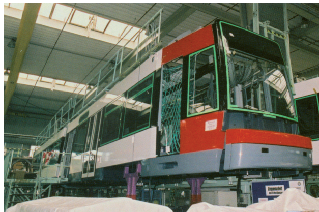
Rys. 15. BSAG, montaż pierwszego wagonu GT8N-1
