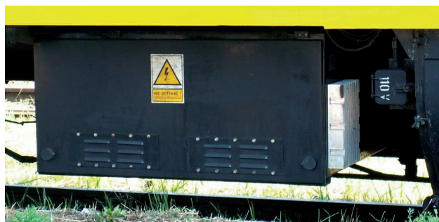
Przetwornica statyczna U/EN57-2004 zamontowana pod wagonem
