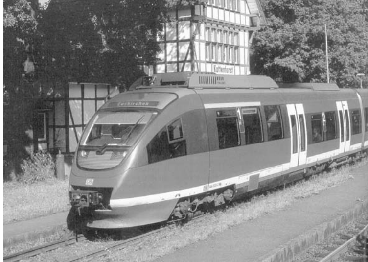
Rys. 21. Spalinowy zespół trakcyjny typu 644 ( Bombardier-Talbot ) z podestami wejściowymi, położonymi na wysokości 800 mm i pojedynczymi, dolnymi stopniami na wysokości 550 mm, otwieranymi wraz z drzwiami. Takie rozwiązanie jest najbardziej korzystne wówczas, gdy są duże różnice wysokości peronów
