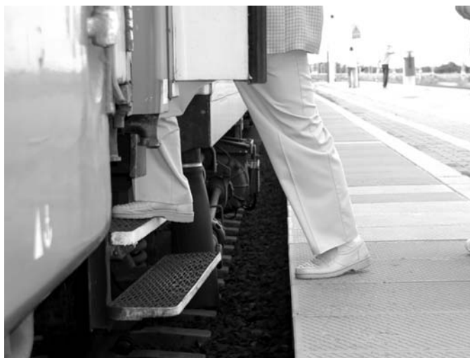
Rys. 29. Typowy sposób wsiadania do wagonu z wejściem czteropoziomym z peronu o wysokości 550 mm. Jest wykorzystywany bezpośrednio stopień drugi, położony w odległości przekraczającej — w warunkach polskich — długość tzw. kroku spacerowego. Perony budowane według Karty UIC-741-OR powinny być położone ok. 60 mm bliżej, co zapewnia korzystniejsze warunki dostępu
