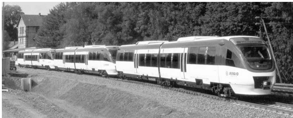
Rys. 22. Trzy spalinowe zespoły trakcyjne produkcji Bombardier-Talbot , mające podesty wejściowe na wysokości 960 mm i przeznaczone do kursowania na odcinku Kaarst—Mettmann
