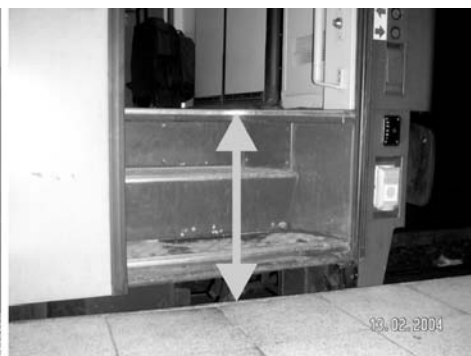
Rys. 31. Całkowita wysokość do pokonania między peronem o wysokości 760 mm a wejściem czteropoziomym wynosi 490 mm
