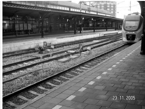
Rys. 8. Typowe w Holandii wysokie perony na stacji Utrecht. Odległość pionowa toru od powierzchni peronu wynosi 975 mm
