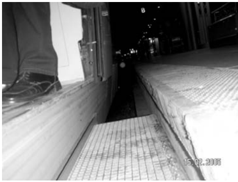
Rys. 23. Unikalna budowa wejścia wagonu motorowego, polegająca na całkowitym zakryciu przestrzeni między wagonem a peronem dzięki wysuwaniu dolnemu stopniowi opierającemu się o ściankę peronową
