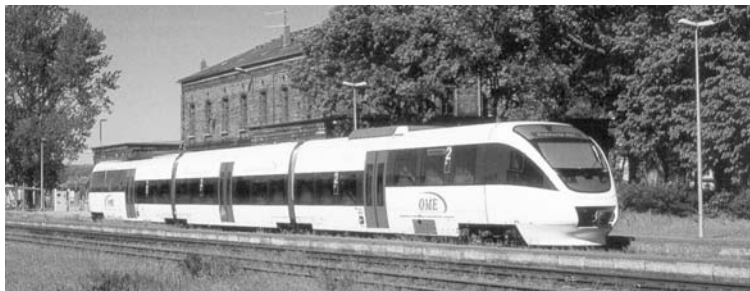
Rys. 13. Spalinowy zespół trakcyjny typu 644 ( Bombardier-Talbot ) przeznaczony do kursowania na sieci byłej NRD, mający podesty wejściowe na wysokości 590 mm (odcinek Passewalk—Schwerin )
