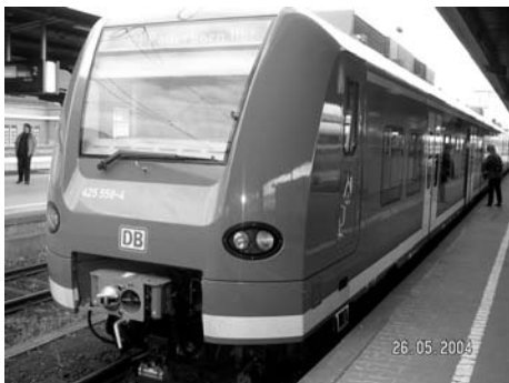
Rys. 25. Elektryczny zespół trakcyjny typu 425 kolei niemieckich (firmy Adtranz ), przeznaczony do ruchu regionalnego.
