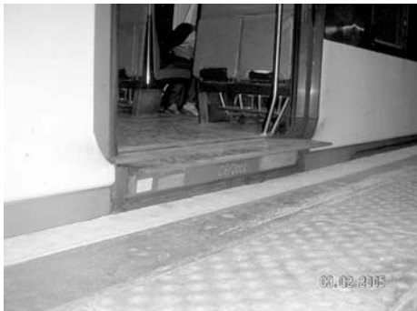
Rys. 15. Paryski przystanek osobowy RER na linii B: elektryczny zespół trakcyjny przy peronie o wysokości ok. 960 mm. Widoczna duża odległość pionowa między dolnym stopniem a peronem
