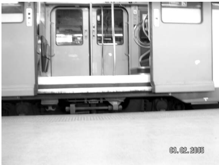
Rys. 14. Paryski przystanek osobowy RER na linii C: piętrowy, elektryczny zespół trakcyjny przy peronie o wysokości ok. 300 mm. Widoczna duża odległość pionowa między dolnym stopniem a peronem, położonym na układzie łuków odwrotnych o małych promieniach
