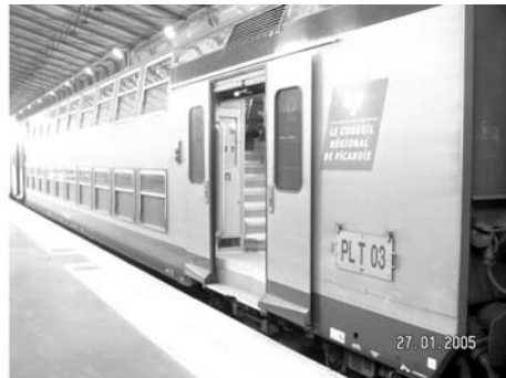
Rys. 16. Wagon piętrowy SNCF przystosowany do peronów niskich i wysokich (960 mm). Różnica wysokości między stopniem a podestem wynosi ok. 300 mm. Wąski dolny stopień (o zmiennej szerokości) umożliwia maksymalne przybliżenie podestu do peronów wysokich
