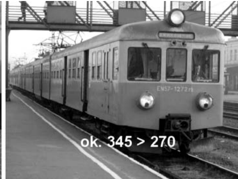
Rys. 36. Dolny stopień elektrycznych zespołów trakcyjnych EN57, zatrzymujących się przy peronach o wysokości 300 mm
