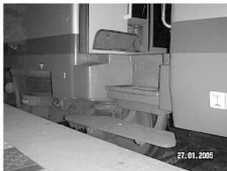
Rys. 10. Wagon pociągu dalekobieżnego SNCF z obniżonym podestem wejścia trzypoziomowego. Dolny, szeroki stały stopień zachęca do korzystania z niego, jednak powoduje, że górny jest odsunięty bardziej od peronów wyższych niż 550 mm
