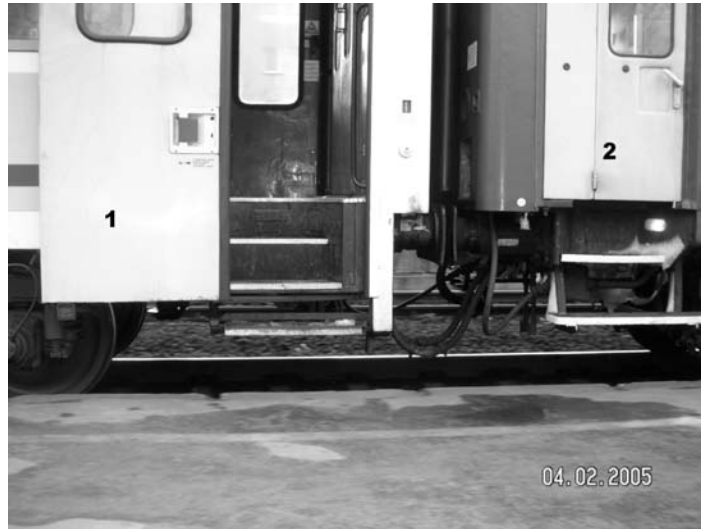
Rys. 1. Dwa warianty budowy wejść wagonowych.
