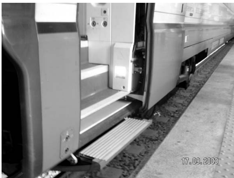
Rys. 11. Włoski zespół trakcyjny ETR z otwartym wraz z drzwiami dolnym stopniem na poziomie ok. 560 mm, przy peronie o wysokości 550 mm
