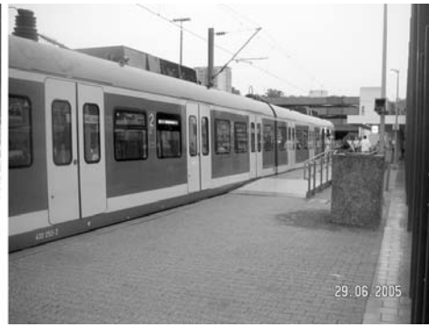
Rys. 24. Elektryczny zespół trakcyjny kolei niemieckich typu 423 (firmy Adtranz ) przeznaczony do ruchu aglomeracyjnego, mający podesty wejściowe na wysokości 995 mm bez stopni
