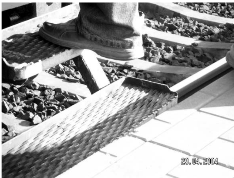
Rys. 32. Typowe rozstawienie stóp podczas wchodzenia do wagonu z wejściem czteropoziomowym z peronu o wysokości 760 mm. Odległość pozioma nie przekracza tzw. kroku spacerowego
