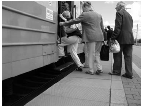
Rys. 37. Typowy sposób wsiadania z peronu o wysokości 550 mm do elektrycznego zespołu trakcyjnego EN57.
