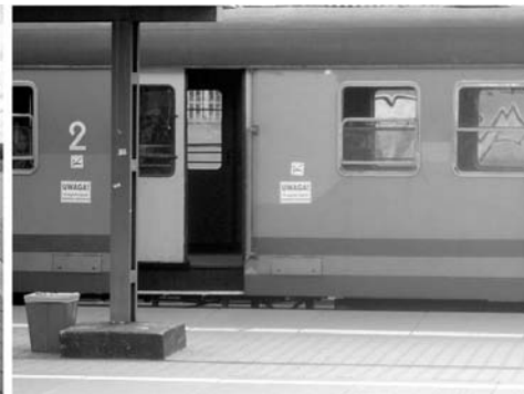
Rys. 38. Mińsk Mazowiecki: perony o wysokości 760 mm zapewniają dogodny dostęp do stopnia drugiego
