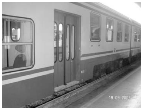
Rys. 3. Stacja Rzym Termini: wagon z niskim podestem wejściowym przeznaczony do ruchu regionalnego na kolejach włoskich.
