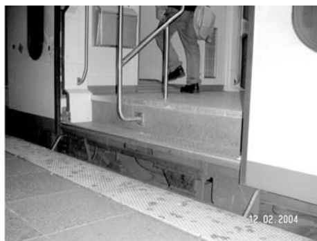
Rys. 44. Dwupoziomowe wejście do wagonu piętrowego z peronu o wysokości 760 mm. Dolny stopień rozkładany gwarantuje dostęp z peronów niskich; warunki pożądane do uzyskania w ramach modernizacji krajowych EN57, przez zastosowanie rozkładanego stopnia dolnego, umożliwiającego przybliżenie stopnia górnego
