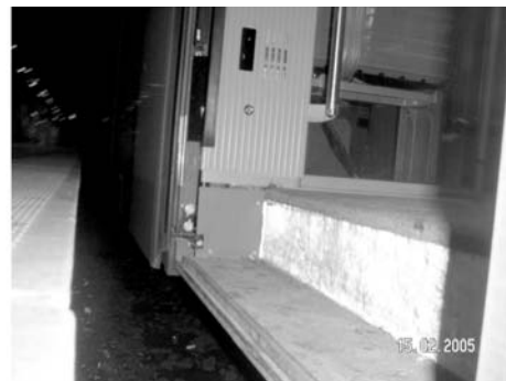
Rys. 26. Elektryczny zespół trakcyjny nowej generacji ET425 przy peronie o wysokości 760 mm.
