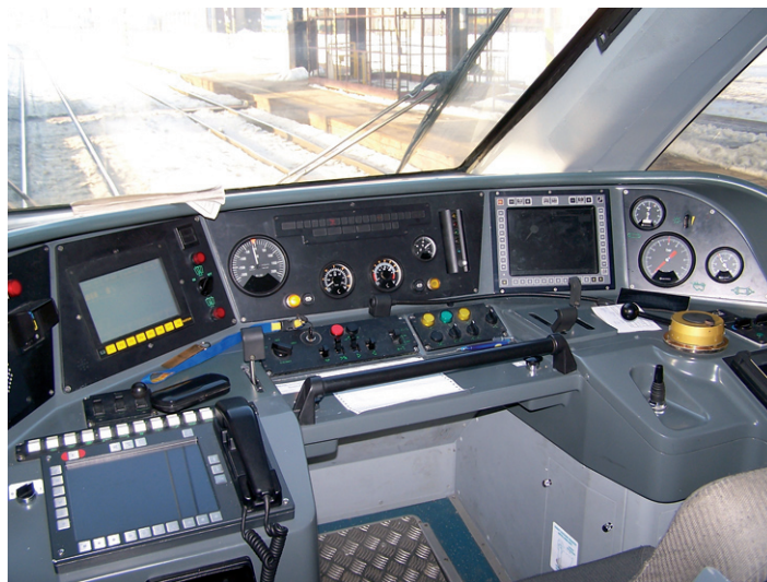
Wnętrze kabiny maszynisty. Nie jest ona zbyt obszerna, ale zapewnia bardzo dobre warunki pracy dla maszynisty i pomocnika (16.01.2006 r.) Fot. R. Rusak
